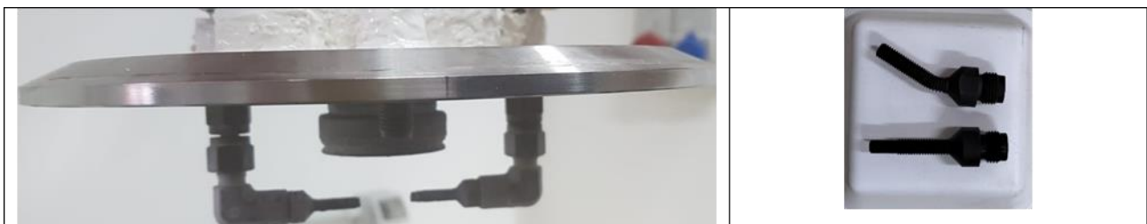
Figura 13. Configurazione iniezione esterna con possibilità di iniezione polveri diritta o inclinata
