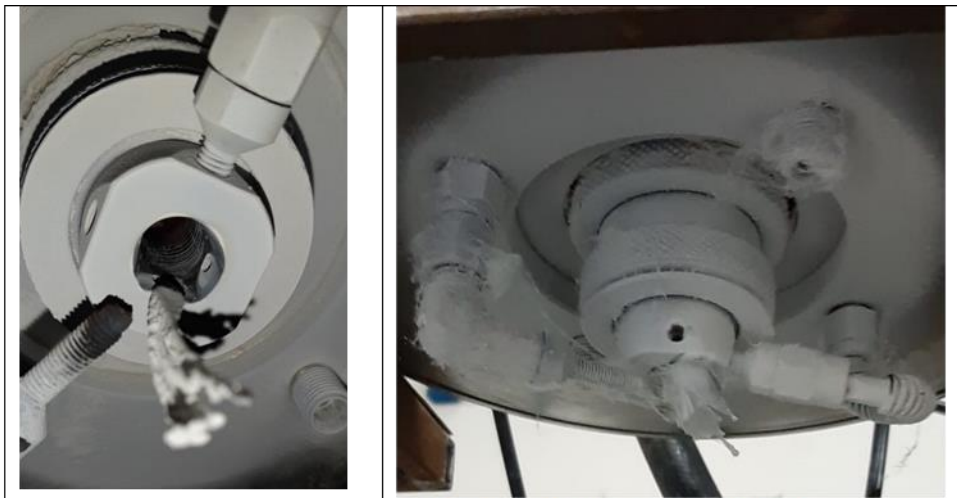
Figura 12. Test allumina con polvere iniezione interna (ALPL11-ALPL12)
