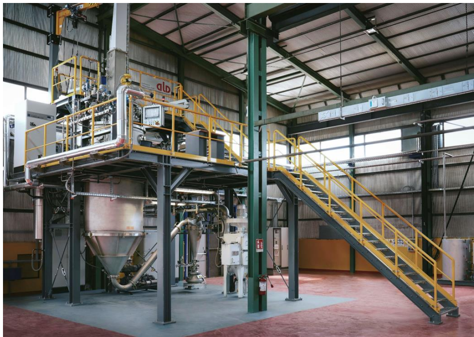
Figura 3: impianto EIGA per produzione di polveri per processi additivi
