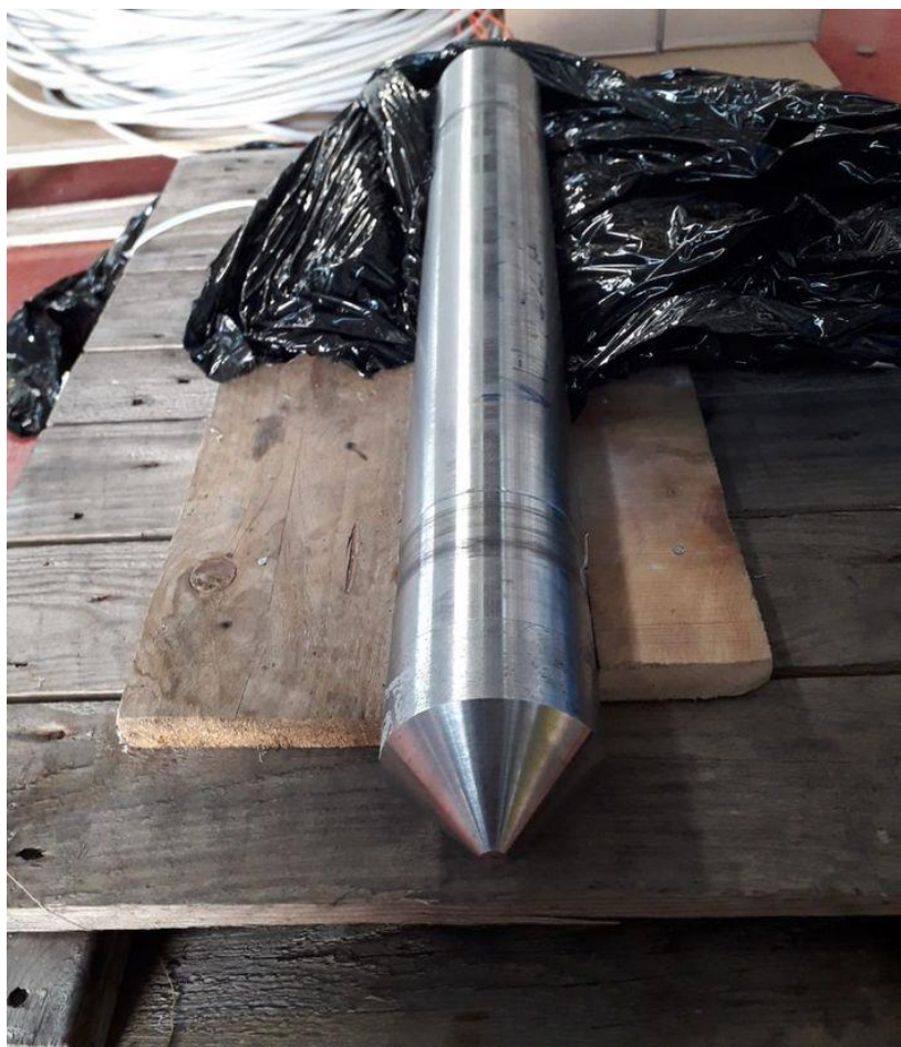
Figura 2: barra di lega ferritica prodotta mediante processo VIM
