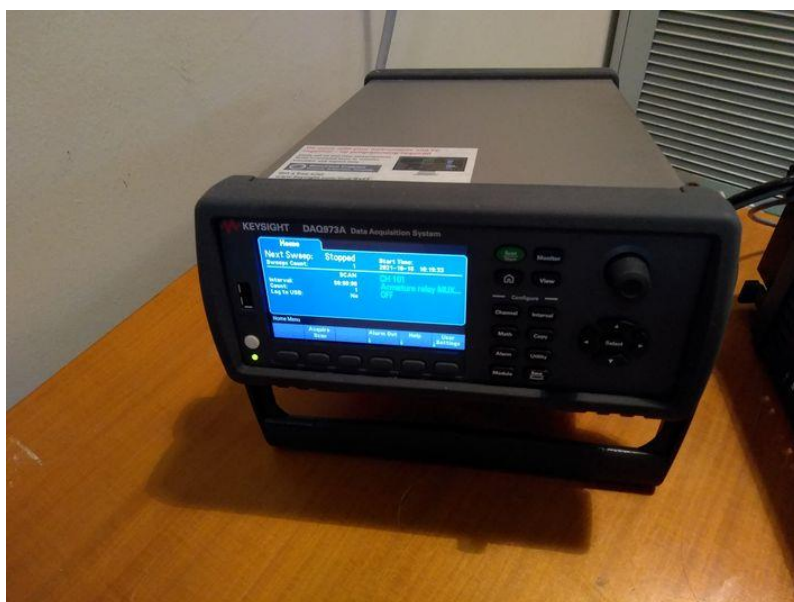
Figura 4: immagine del datalogger utilizzato per l'acquisizione dei dati di misura del banco prova scambiatori
