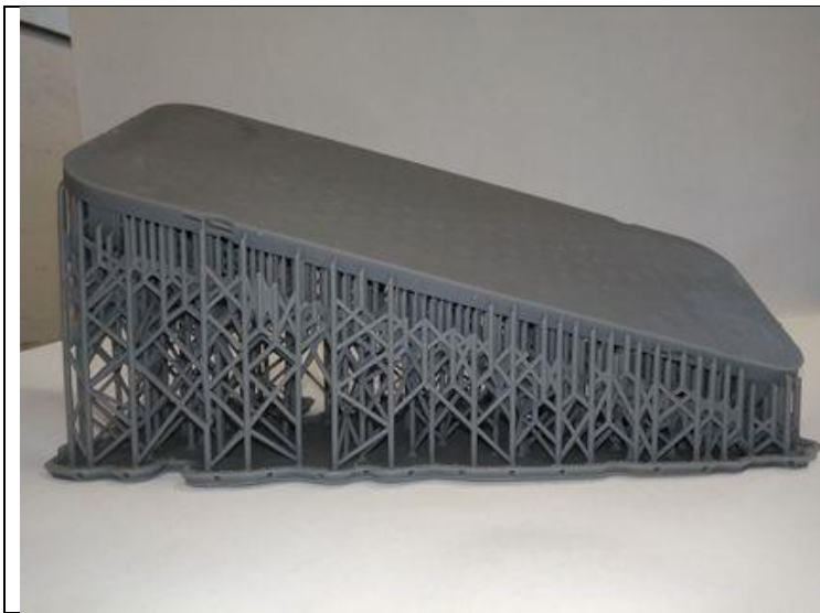
Figura 7: immagini dello scambiatore di prova realizzato mediante processo SLA
