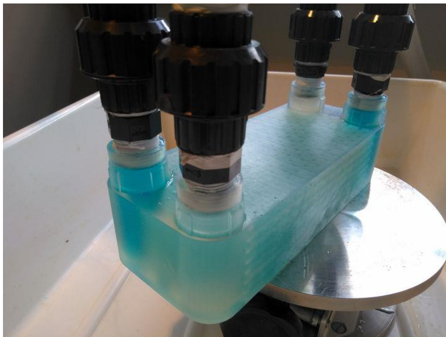
Figura 15: immagine di uno scambiatore di calore in materiale polimerico durante i test su banco prova
