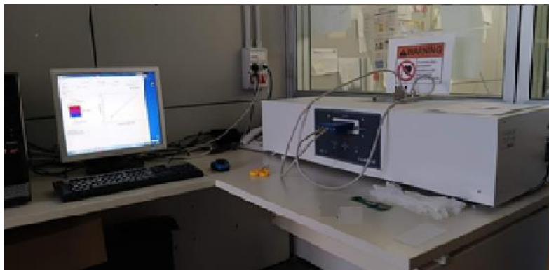
Fig. 9 - Setup LINSEIS per la misura del coefficiente di Seebeck
