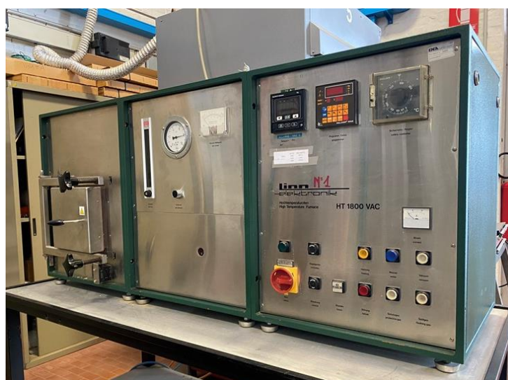
Figura 3. Forno LINN ad atmosfera controllata
