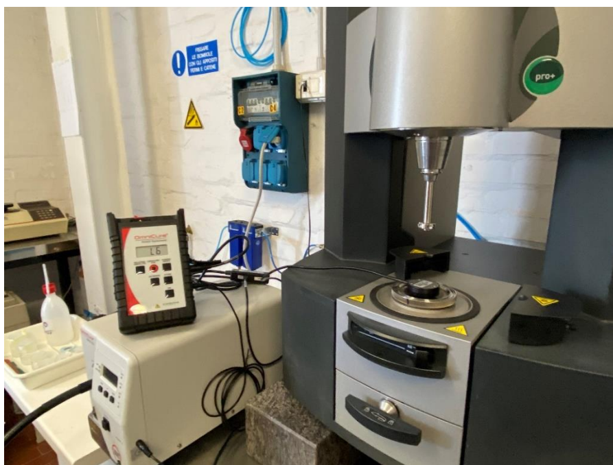
Figura 17. Particolare del radiometro di calibrazione montato, che consente la regolazione dell'irradianza della lampada UV-Vis.
