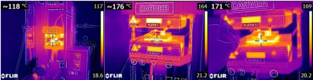
Figura 23. Verifica dell’andamento dei test di consolidamento mediante termo camera
