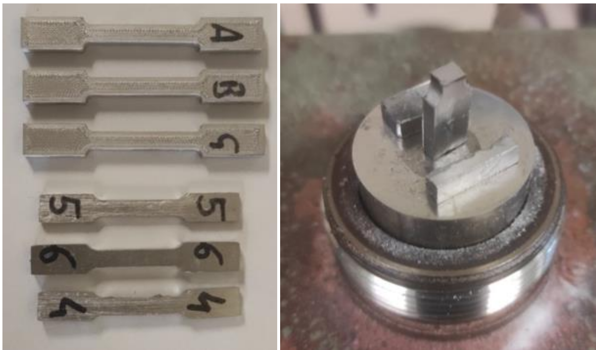
Figura 29. Immagini relative alla preparazione e all'inglobamento dei campioni per le analisi mediante SEM. A destra particolare relativo alla preparativa del campione 4
