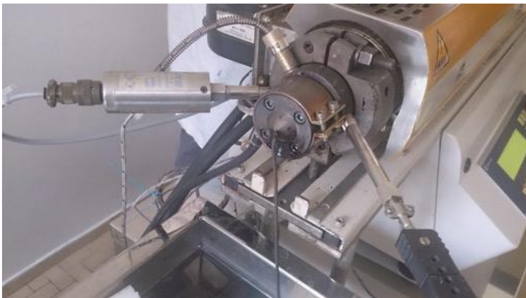
Figura 19. Il filamento composito metallo/legante in uscita dalla filiera viene raffreddato in acqua e successivamente raccolto.
