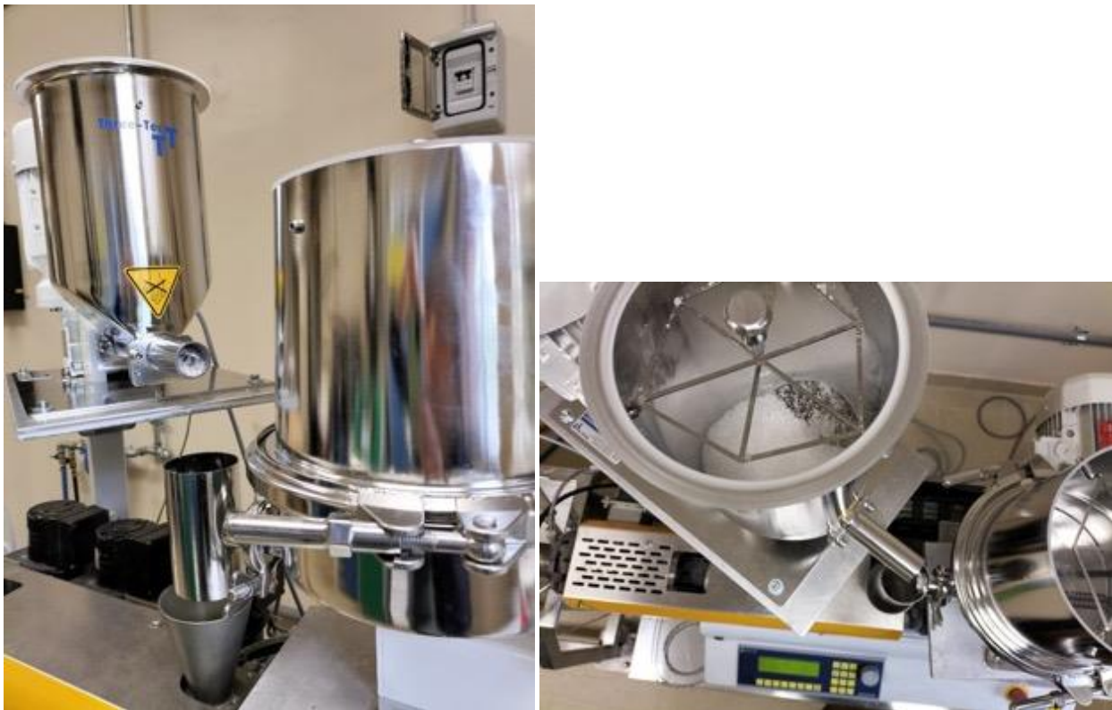
Figura 18. Sistemi dosatori Three Tech GmbH in equipaggiamento alla linea di estrusione da banco Dr. Collin. Sinistra: la configurazione utilizzata per la preparazione del composito permette il dosaggio contemporaneo dei componenti. Destra: vista dall'alto dei due dosatori a singola coclea per il dosaggio della miscela legante e doppia coclea per il dosaggio della polvere metallica, rispettivamente.
