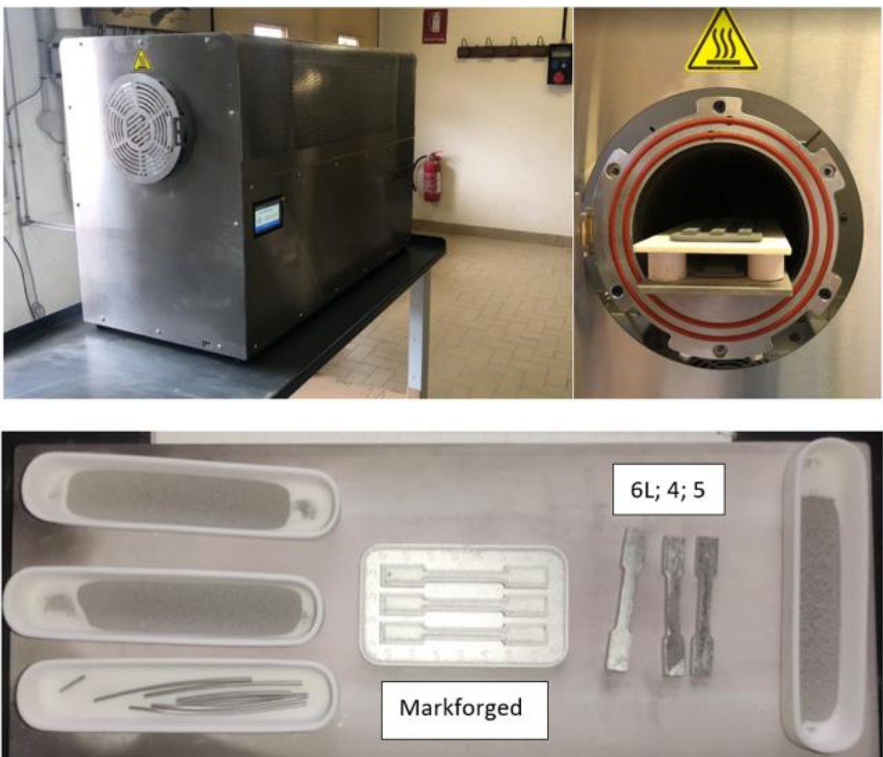
Figura 27. Trattamento di sintering. In alto: fornace in dotazione al sistema di stampa metallica Metal X di Markforged e inserimento del supporto porta campioni. In basso: provini dopo sinterizzazione.
