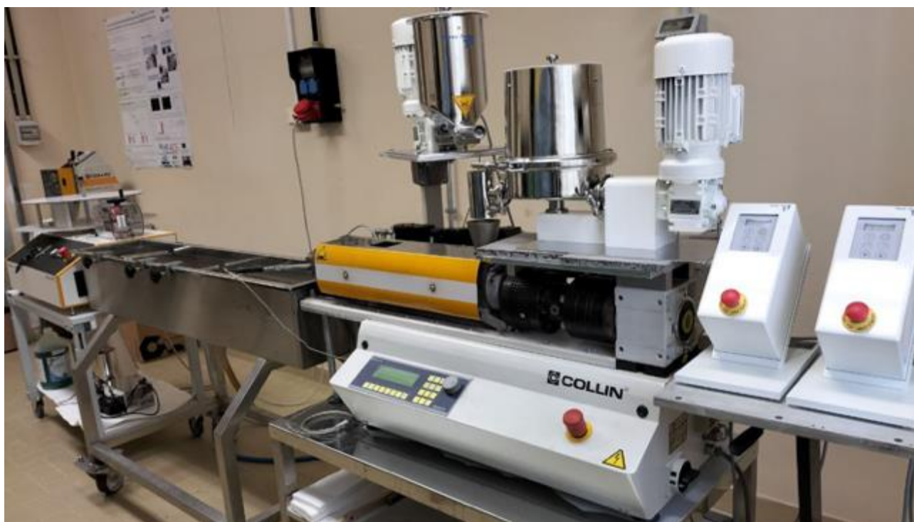
Figura 17. Linea di estrusione da banco Dr. Collin, installata presso il Centro Ricerche Enea Casaccia a Roma.
