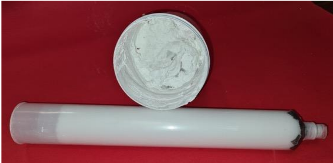
Figura 14. Pasta ceramica preparata per la stampa dell'alluminio titanato in verde con polvere Zircomet (Output LA 3.3 per LA 4.6)
