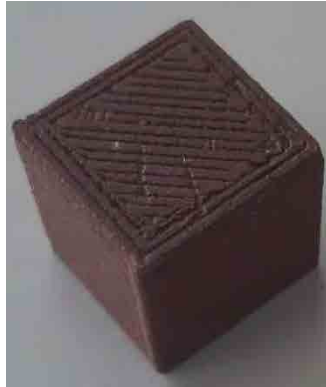
Figura 27. Cubetto l=10 mm stampato con filamento VF caricato in rame
