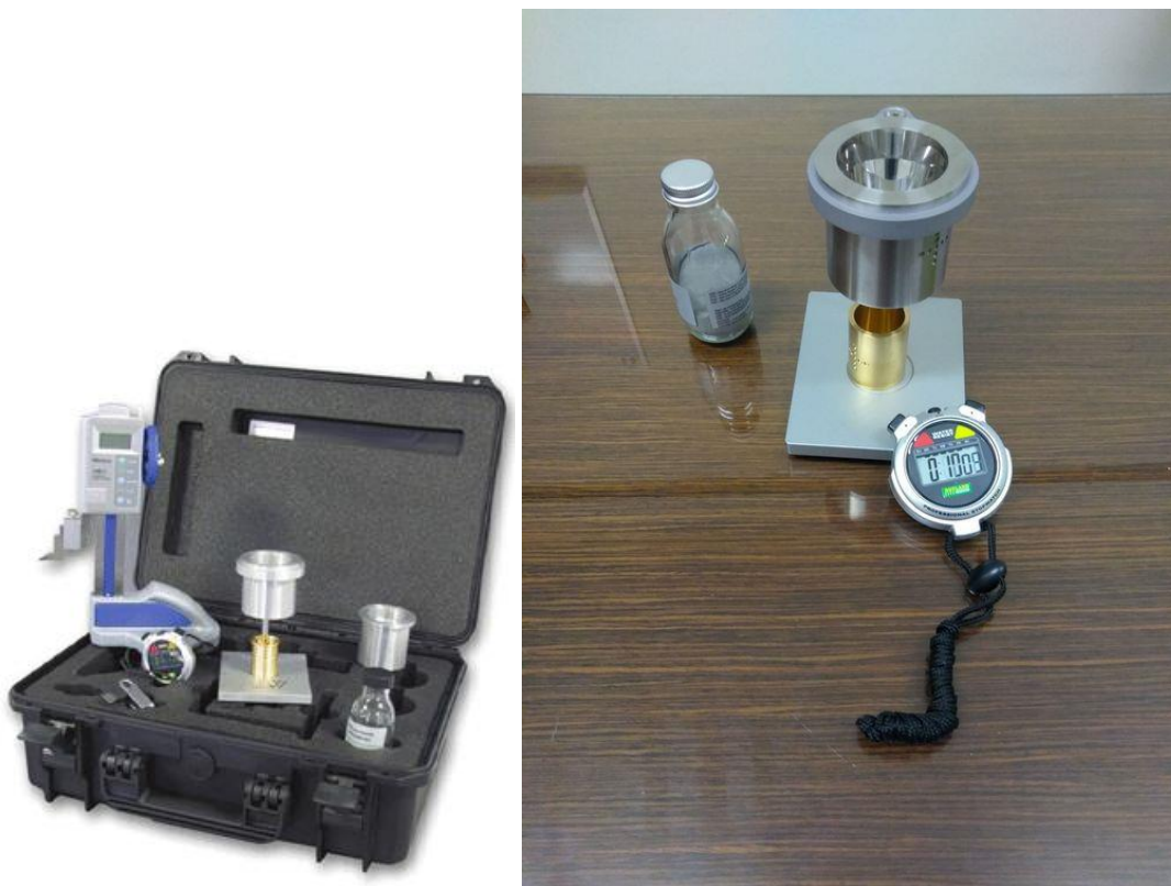
Figura 2: kit per la misura della scorrevolezza della polvere per tecnologie additive
