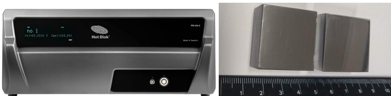
Figura 13: strumento per la misura della conducibilità termica e guance in lega ferritica con superficie rettificata sulle quali sono state effettuate le misure.
