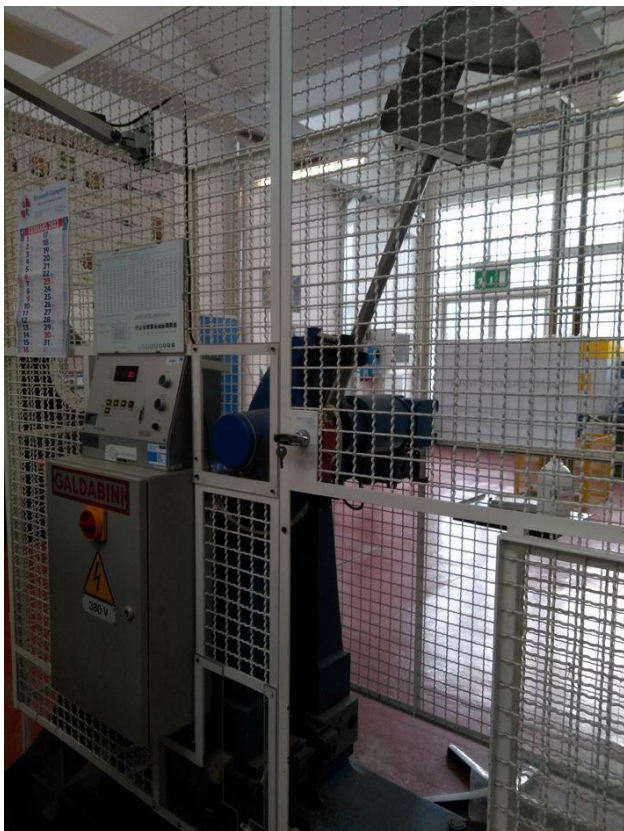
Figura 9: pendolo di Charpy utilizzato per le misure di resilienza.
