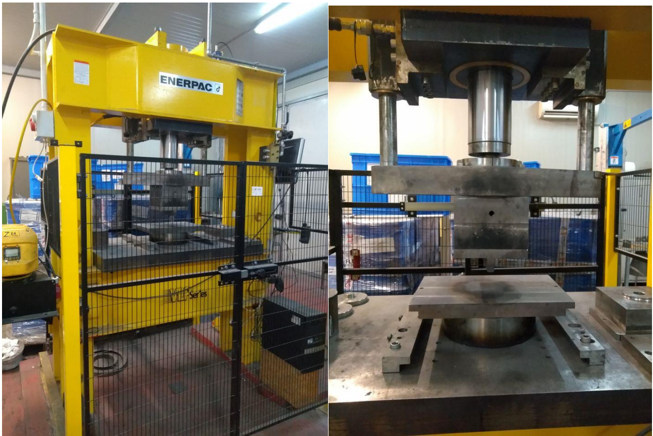
Figura 3: pressa utilizzata per la forgiatura della barra in lega ferritica e particolare.
