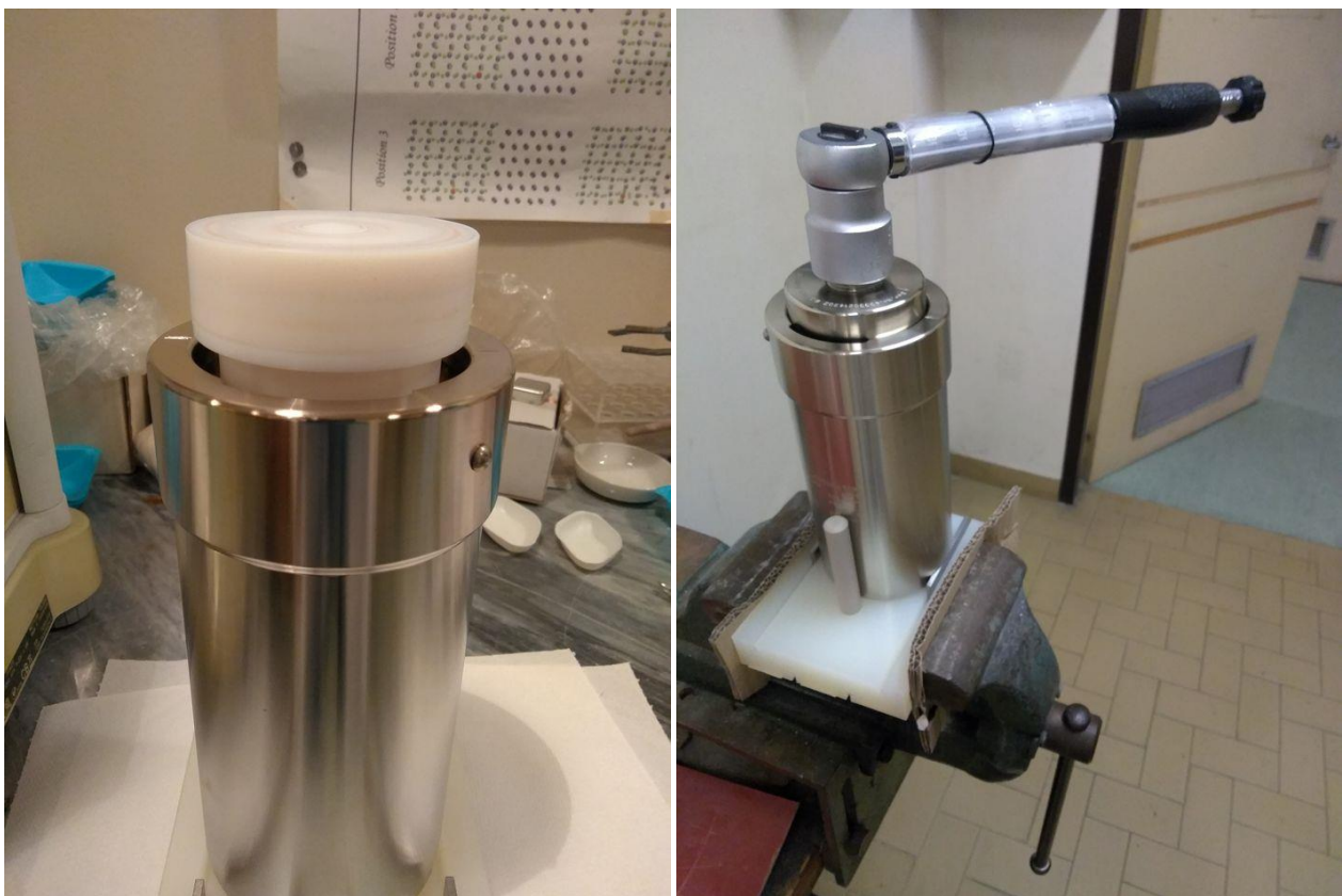
Figura 16: immagine del reattore per le prove di corrosione durante la fase di serraggio.
