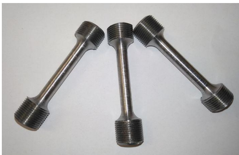
Figura 7: provini di lega ferritica dopo pressatura per prove di trazione secondo la norma DIN-50125.
