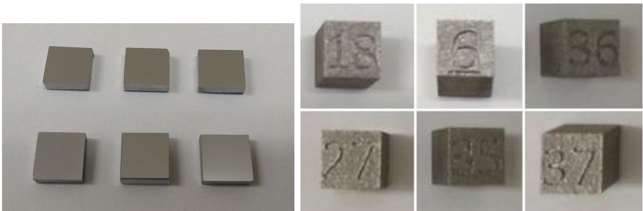
Figura 15: immagine dei campioni prima delle prove di corrosione in soluzione acqua-ammoniaca.
