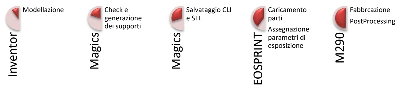
Figura 102 Workflow della produzione delle palette
