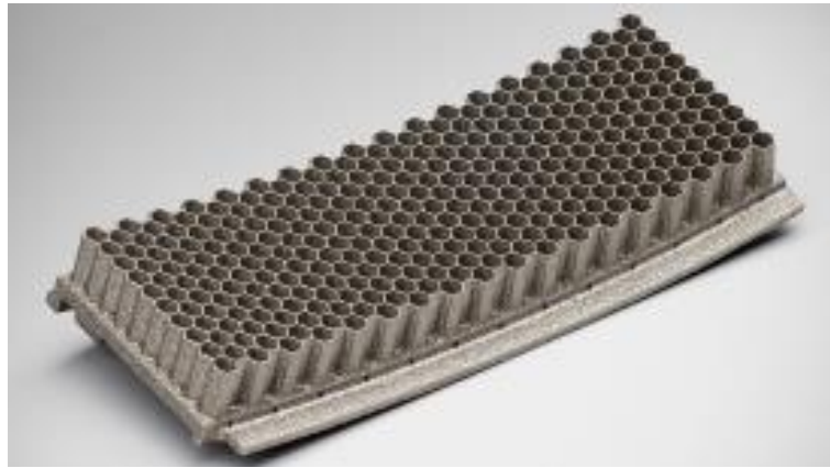
Figura 11 Stato di deformazione indotto in un pannello a cella esagonale evidenziato dopo il distacco dalla tavola di fabbricazione
