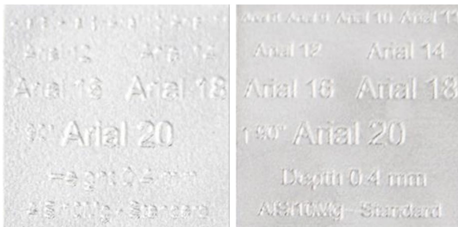
Figura 69 Scritta in altorilievo (sinistra) e bassorilievo (destra) su un componente in AlSi10Mg
