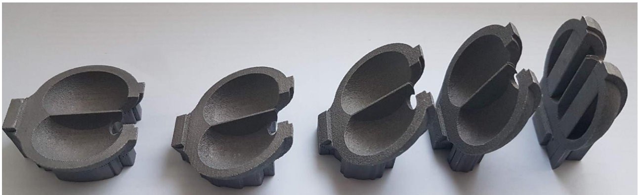
Figura 114 Palette dopo la fase di fabbricazione.
