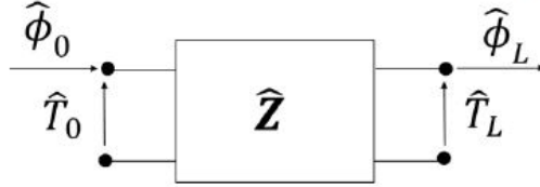
Figura 56 – Quadripolo rappresentante la parete piana omogenea nello spazio della trasformata di Laplace.
