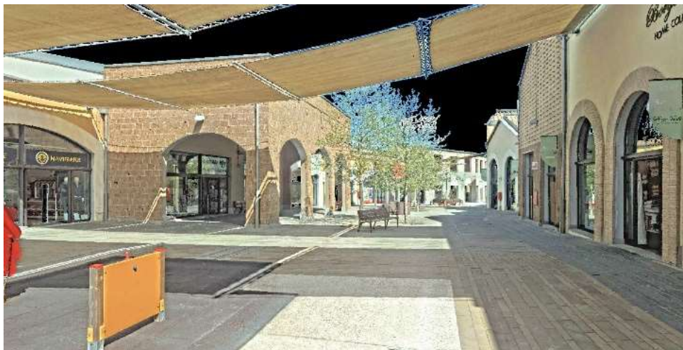
Figura 4: Esempio di rilievo tramite Laser Scanner ( http://lasia.it/rilievo-laser-scanner-ed-bim-connubio-perfetto/ )
