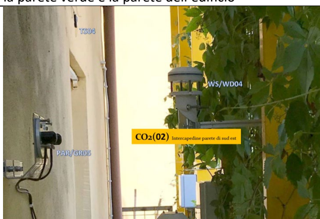
f. Intercapedine della parete esposta a Sud-Est (SE): 1° piano: sensore CO 2 in area equidistante tra la parete verde e la parete dell'edificio
