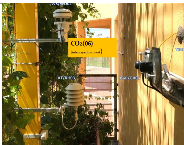
b. Intercapedine della parete esposta a Sud-Ovest (SO), 1° piano: sensore CO 2 in area equidistante tra la parete verde e la parete dell'edificio
