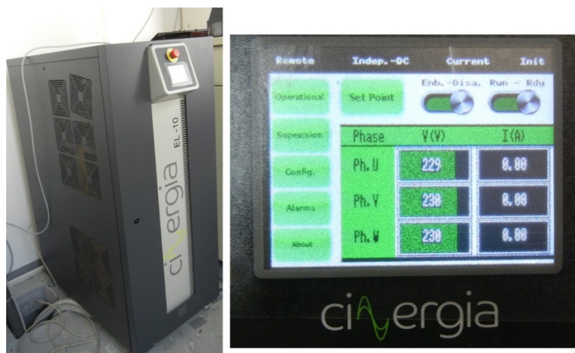
Figura 9: Carico elettronico EL-10 in AC e DC rigenerativo. A destra il display di controllo del dispositivo.
