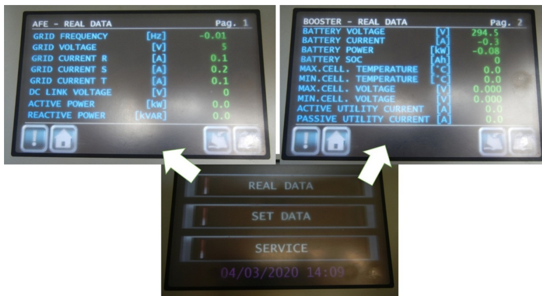
Figura 7: Schermata principale del display del compensatore. In alto le due schermate relative ai real data con le funzioni AFE e Booster.
