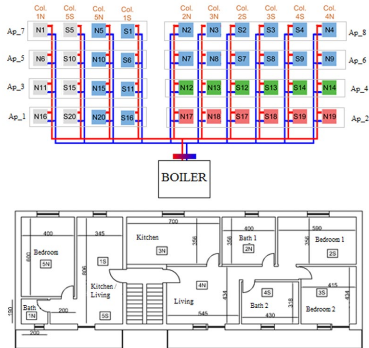
Figura 34 - Set-up sperimentale e corrispondente edificio virtuale
