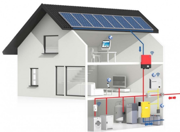
Figura 9: Impianto fotovoltaico associato a pompa di calore
