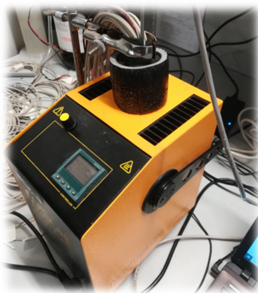
Figura 49. Bagno termostatico utilizzato per la calibrazione dei sensori NTC.
