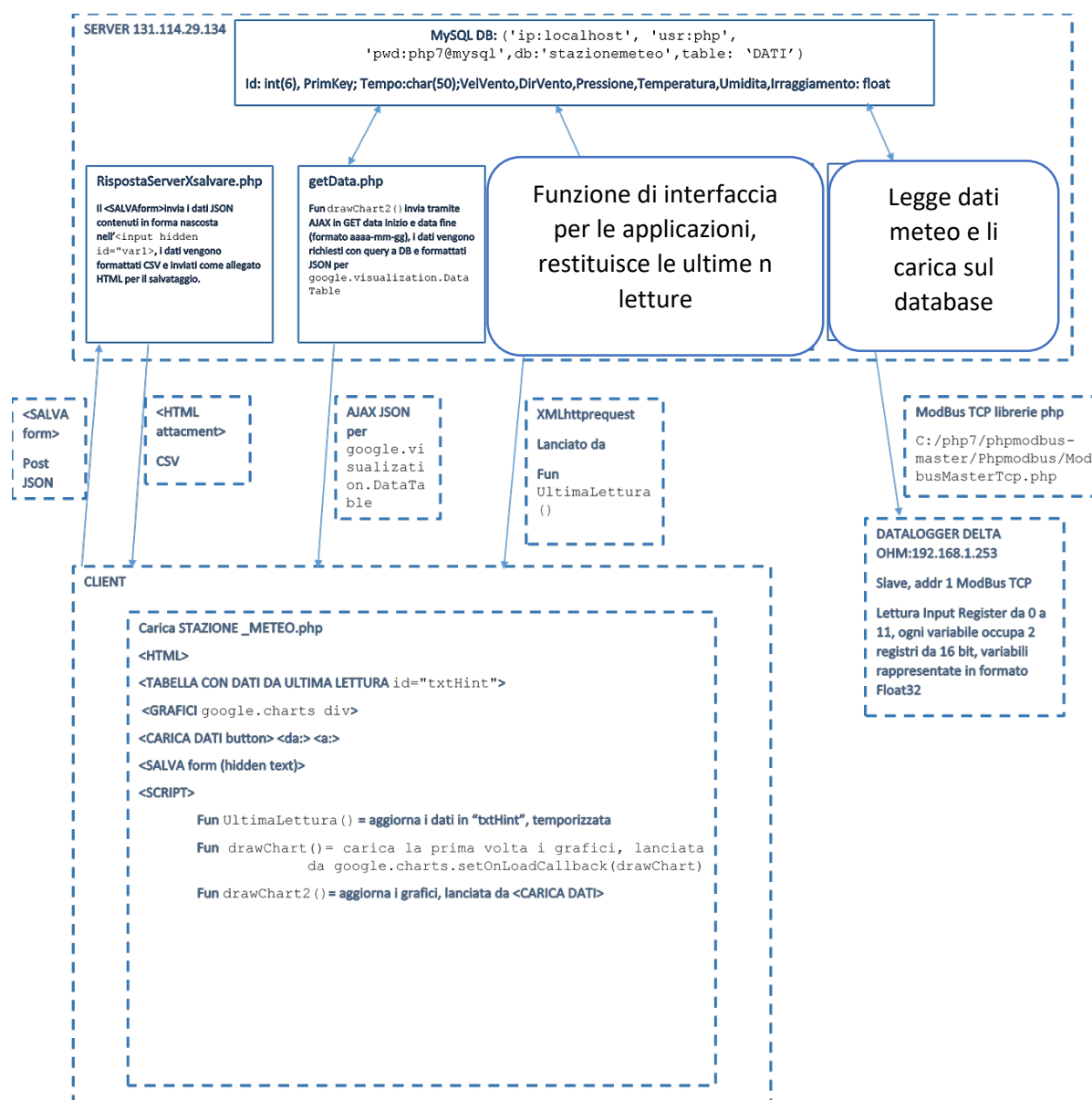
Figura 67. Dati meteo: struttura server-client-stazione meteo.
