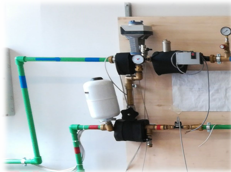
Figura 47. Gruppo idronico dell'emulatore di edificio.
