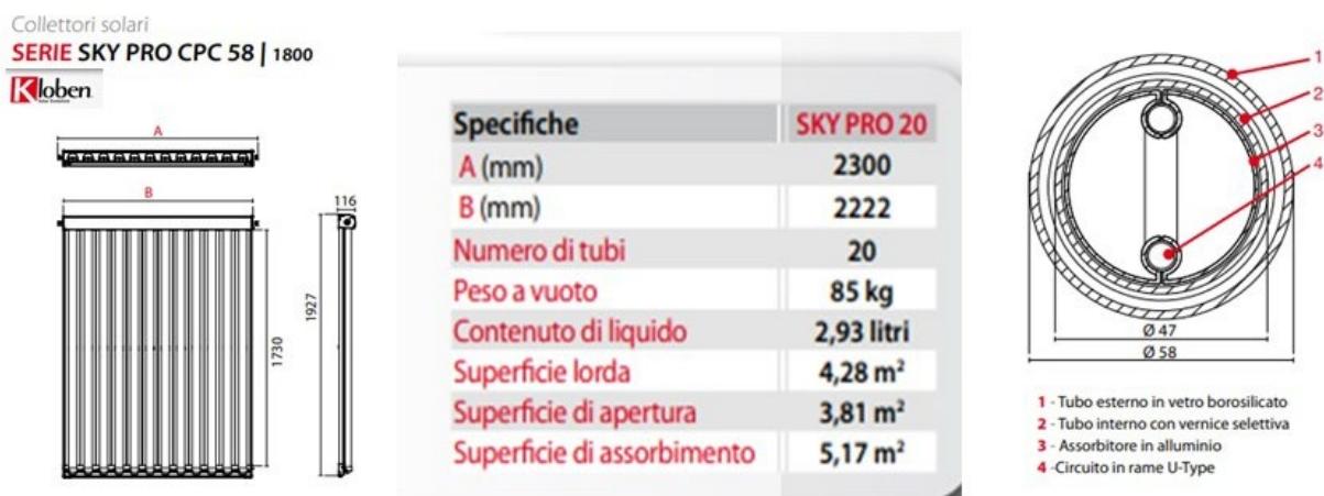
Figura 5. Caratteristiche geometriche e specifiche tecniche dei collettori solari utilizzati nell'impianto di solar cooling presso l'Università di Bari.
