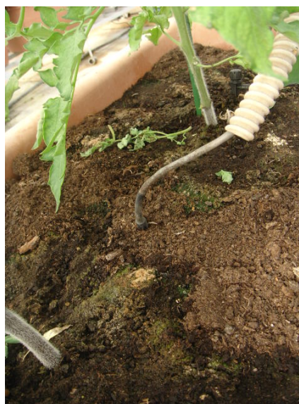
Figura 12. Termistore per la misura della temperatura dell'aria in prossimità delle piante.
