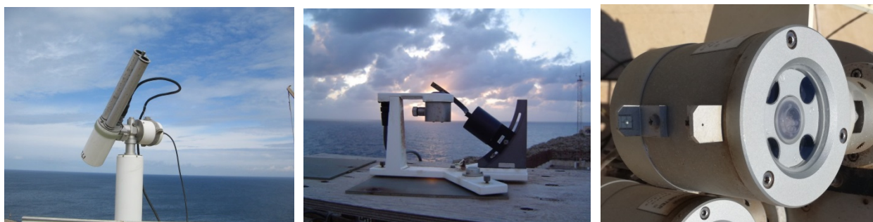
Figura 5.8. Fotometri solari operativi a Lampedusa: a sinistra, Cimel Ce 318; al centro MFRSR-VIS; a destra, Middleton SP02
