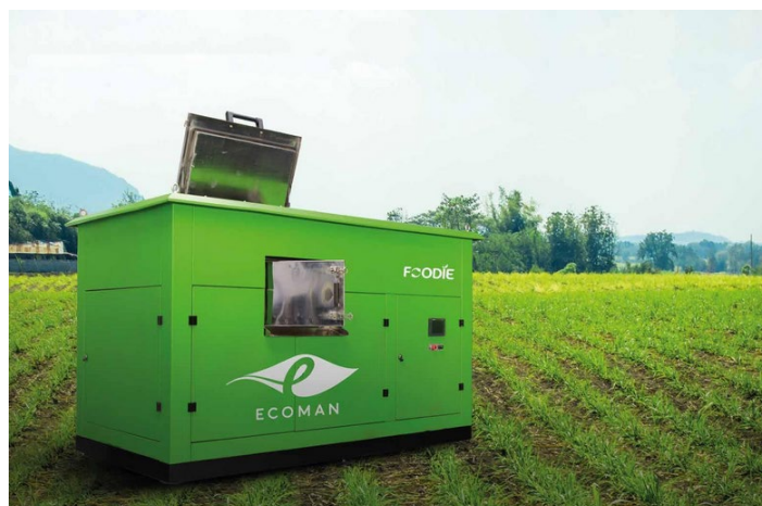
Figura 4.5. Il digestore plug&play "BioBowser Foodie"
