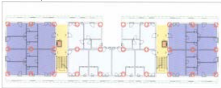
Figura 30. Complesso D'Agostino Costruzioni Generali a L'Aquila: pianta con individuazione degli elementi strutturali e vista tridimensionale d'insieme tratti da [26].
