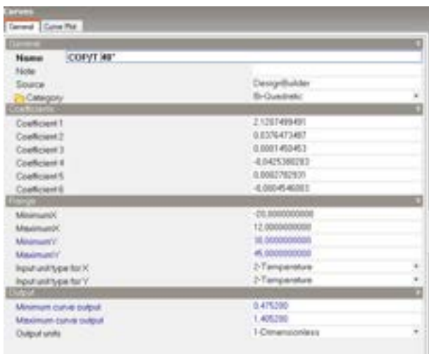
Figura 48. Coefficienti e andamento della curva di variazione del COP in funzione delle temperature
