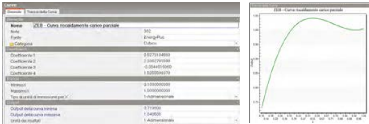
Figura 129. Coefficienti e andamento della curva di correlazione a carico parziale
