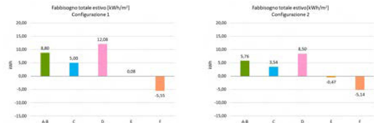
Figura 84. Edificio monofamiliare – Confronto fabbisogno totale estivo nelle 2 configurazioni per le 5 zone climatiche analizzate
