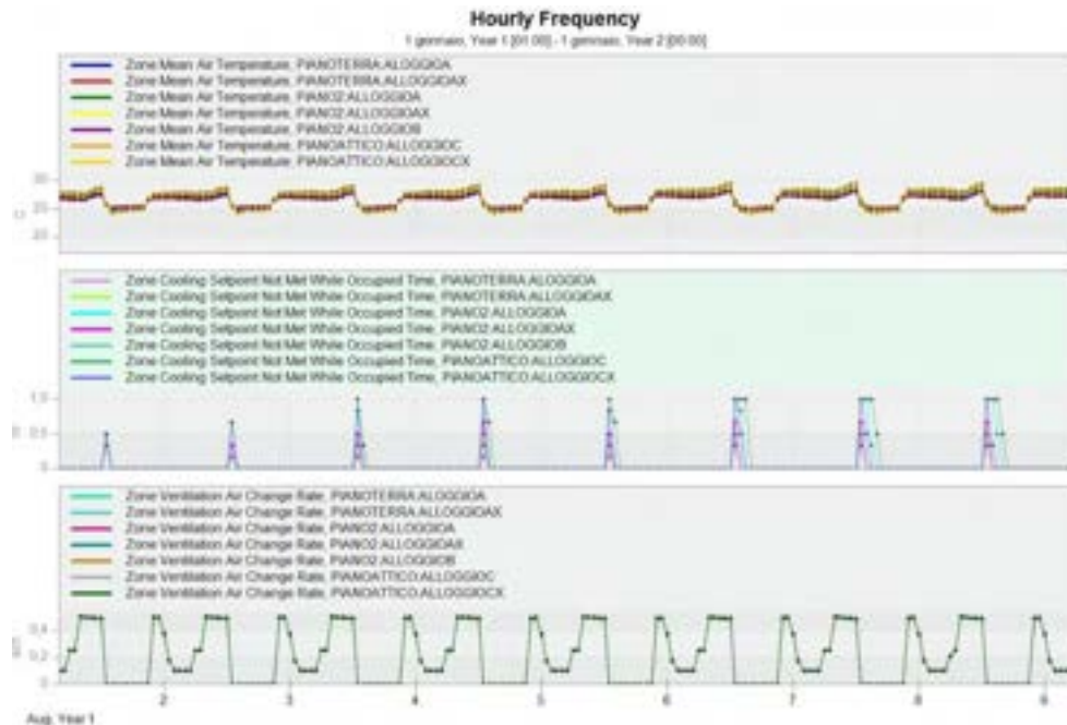
Figura 148. Verifica dell'andamento delle temperature medie dell'aria, delle eventuali ore di discomfort e della coincidenza con il profilo di ventilazione negli alloggi più significativi durante la settimana estiva di progetto (modello di edificio plurifamiliare, configurazione 1, zona climatica D)
