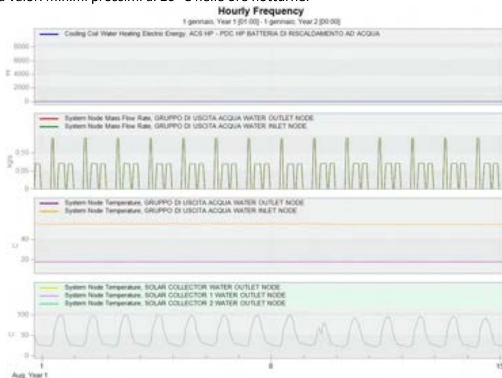
Figura 150. Verifica del funzionamento dell'impianto solare termico – estate (modello di edificio plurifamiliare, configurazione 1, zona climatica D – 1-15 Agosto)
