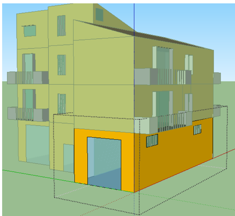
Figura 27: Zona termica 1 (Garage A)
