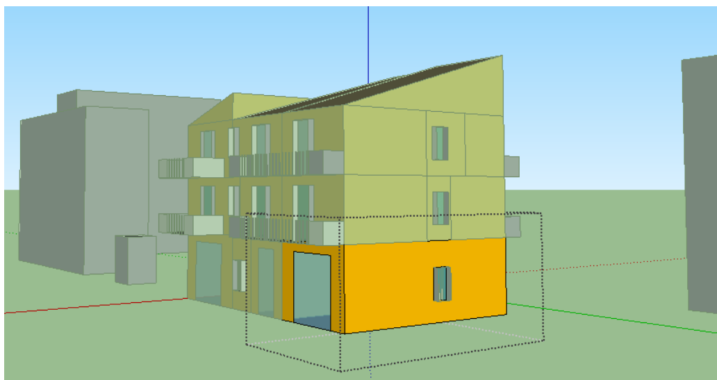
Figura 28: Zona termica 2 (Garage B)
