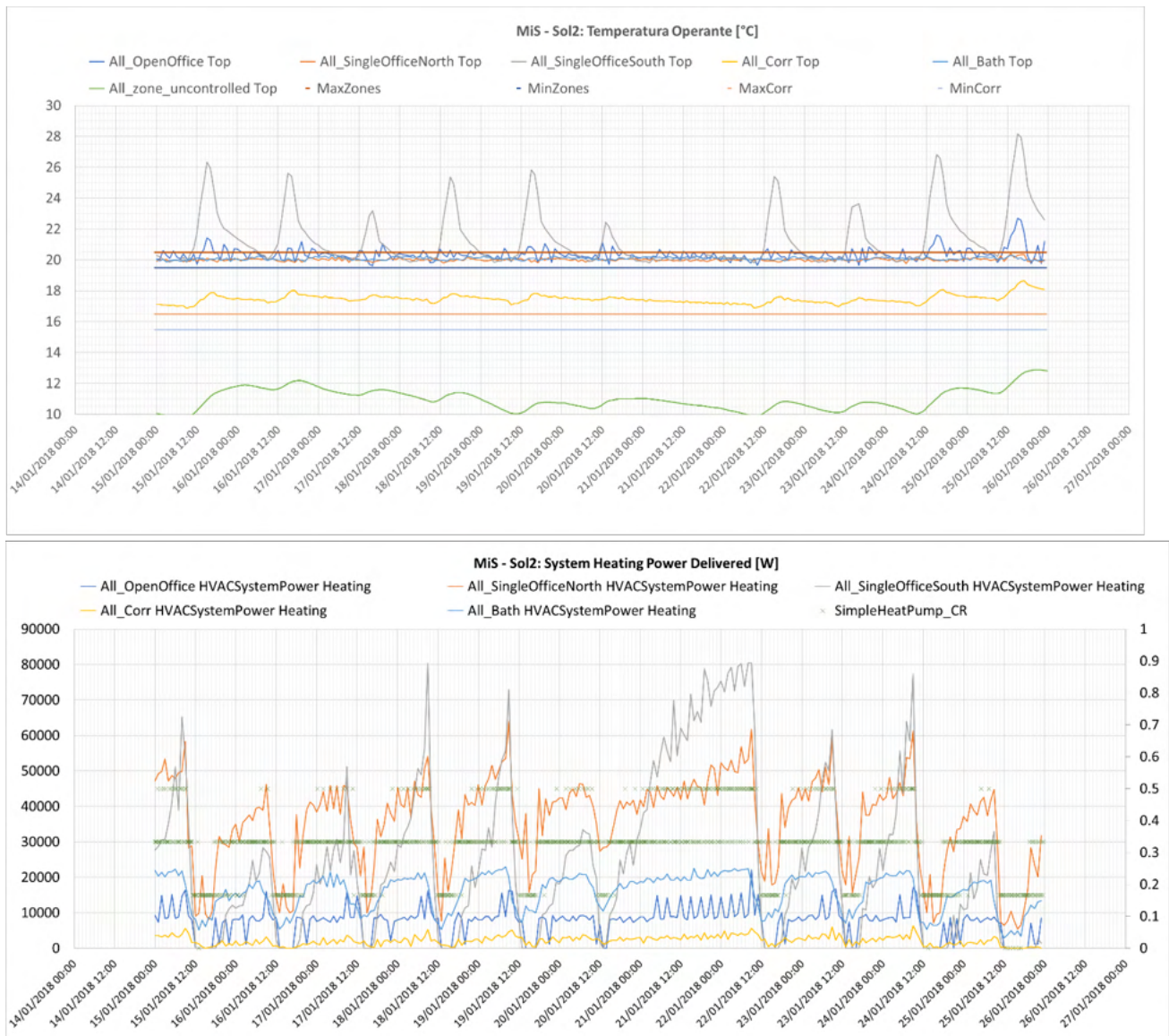
Figura 81. MiS - Sol 2 Temperature operanti e Potenza erogata dai terminali di emissione, ventilconvettori dimensionati per uso standard, periodo invernale.
