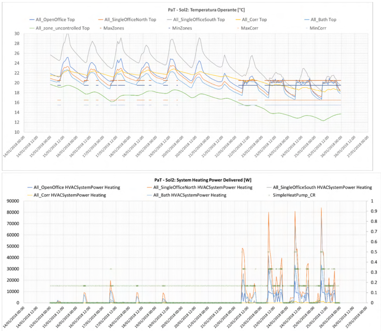
Figura 93. PaT - Sol 2 Temperature operanti e Potenza erogata dai terminali di emissione, ventilconvettori dimensionati per uso tailored, periodo invernale.
