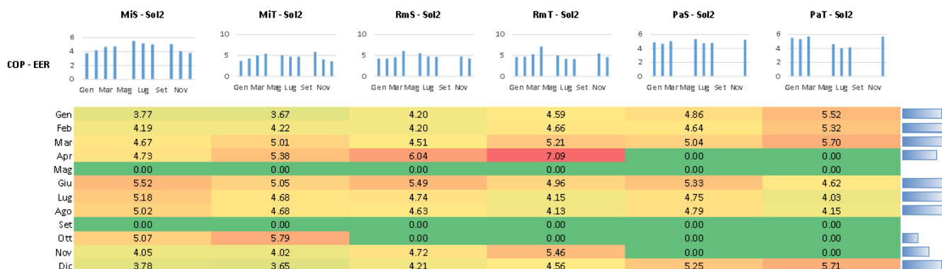
COP/EER con pompa di calore invertibile
