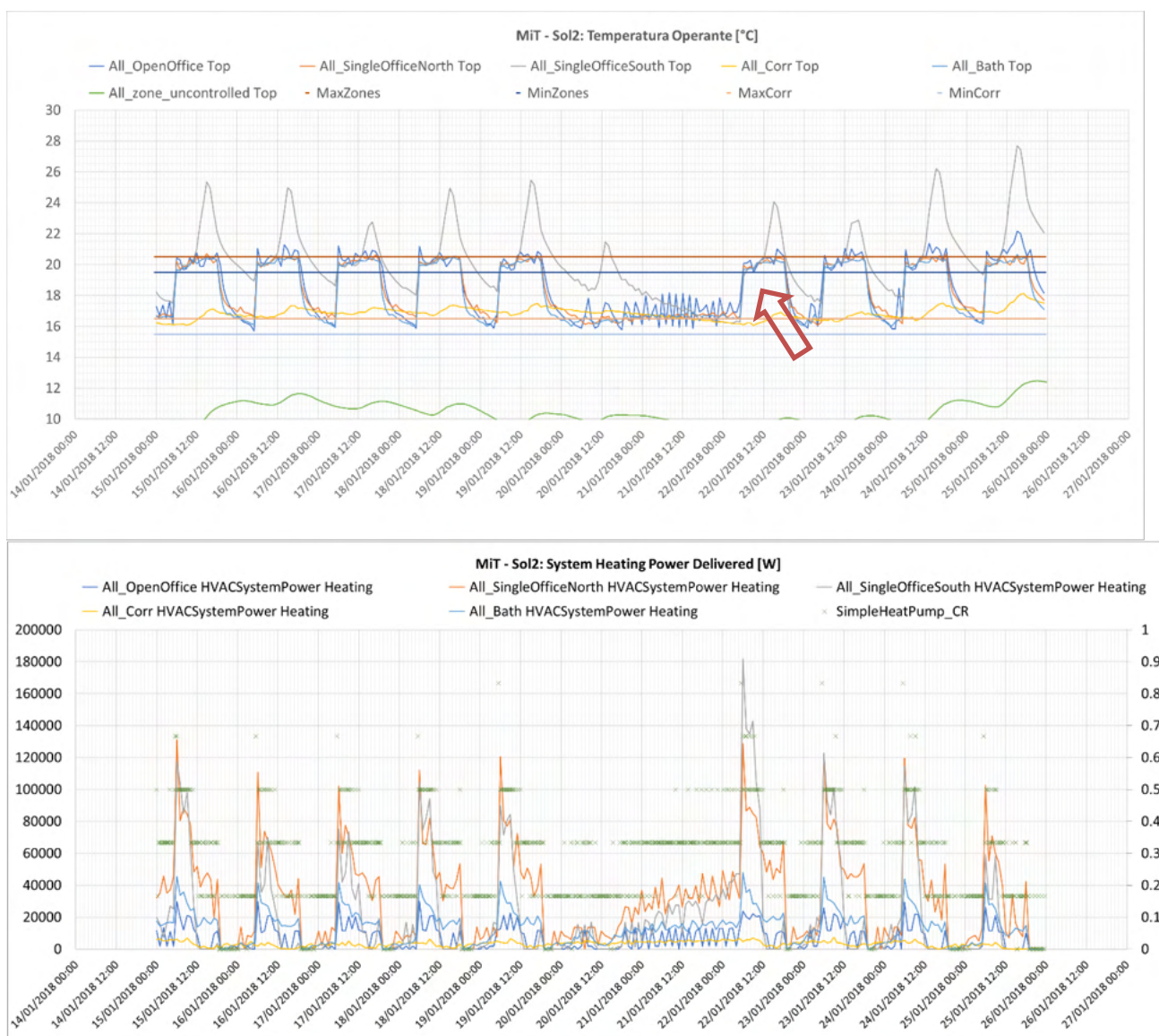
Figura 85. MiT - Sol 2 Temperature operanti e Potenza erogata dai terminali di emissione, ventilconvettori dimensionati per uso tailored, periodo invernale.
