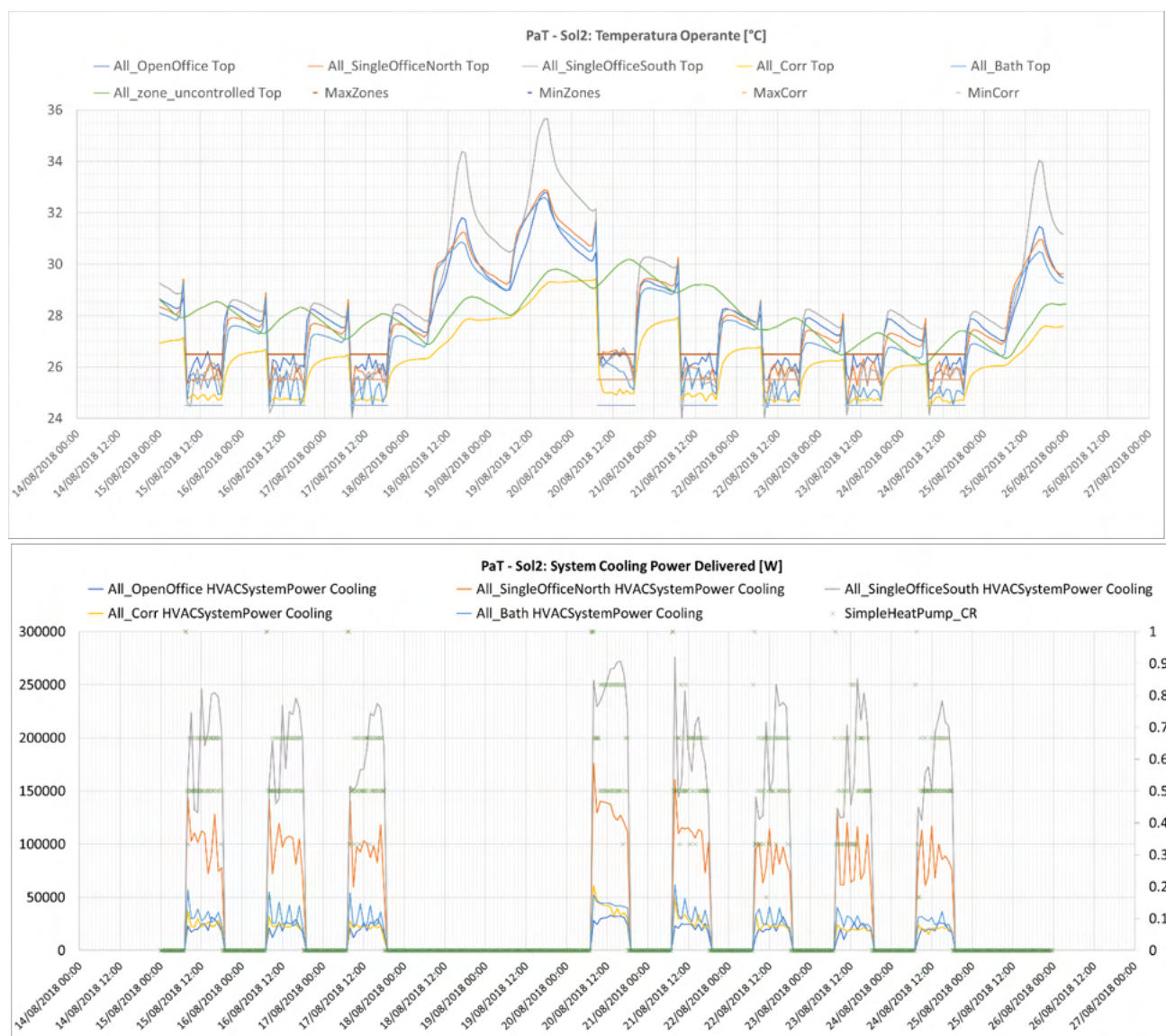
Figura 94. PaT - Sol 2 Temperature operanti e Potenza erogata dai terminali di emissione, ventilconvettori dimensionati per uso tailored, periodo estivo.
