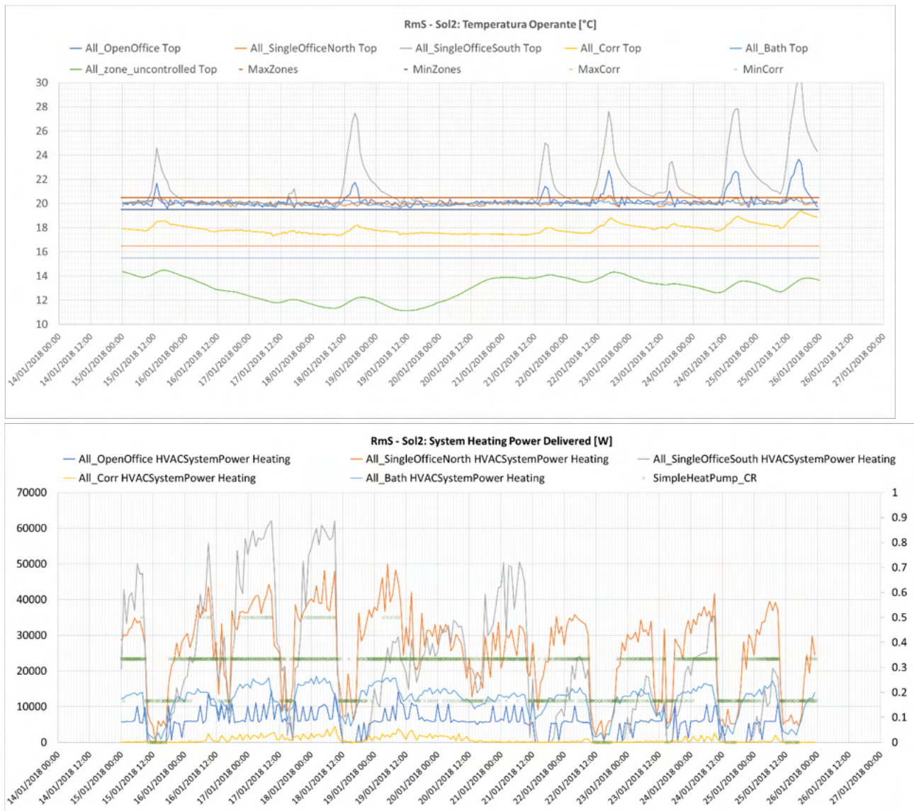
Figura 87. RmS - Sol 2 Temperature operanti e Potenza erogata dai terminali di emissione, ventilconvettori dimensionati per uso standard, periodo invernale.
