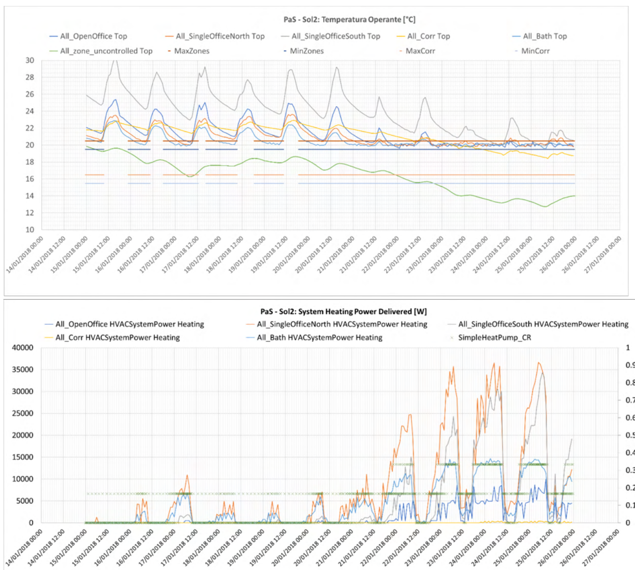
Figura 91. PaS - Sol 2 Temperature operanti e Potenza erogata dai terminali di emissione, ventilconvettori dimensionati per uso standard, periodo invernale.
