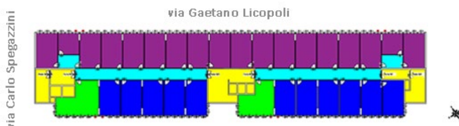
Figura 39. Schematizzazione tridimensionale delle zone termiche nelle quali è stato suddiviso lo spazio climatizzato dell'edificio.
