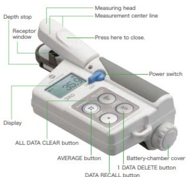
Figura 30. Misuratore di clorofilla portatile SPAD-502 (Konica Minolta)
