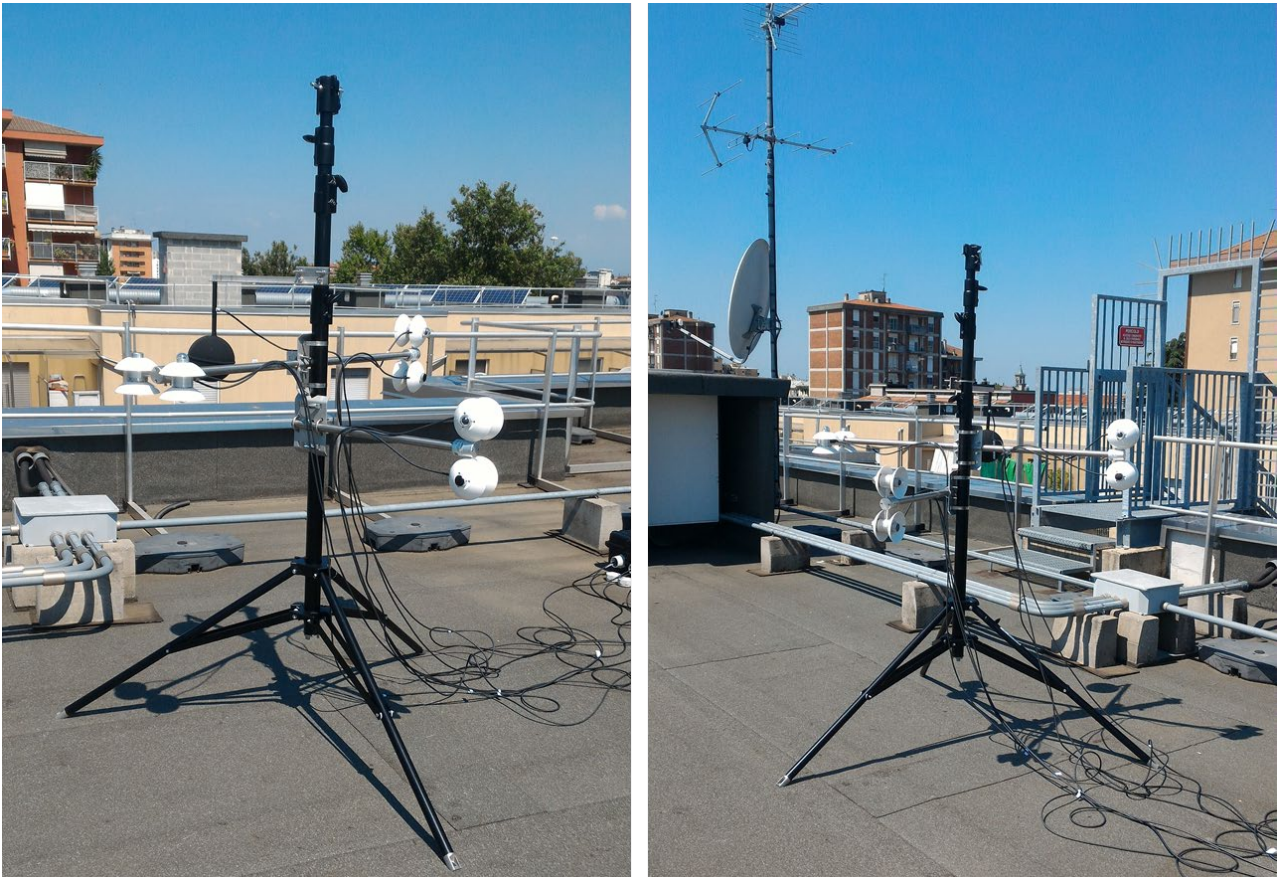
Figura 11. Misure effettuate su una copertura piana con finitura in membrana bituminosa ardesiata
