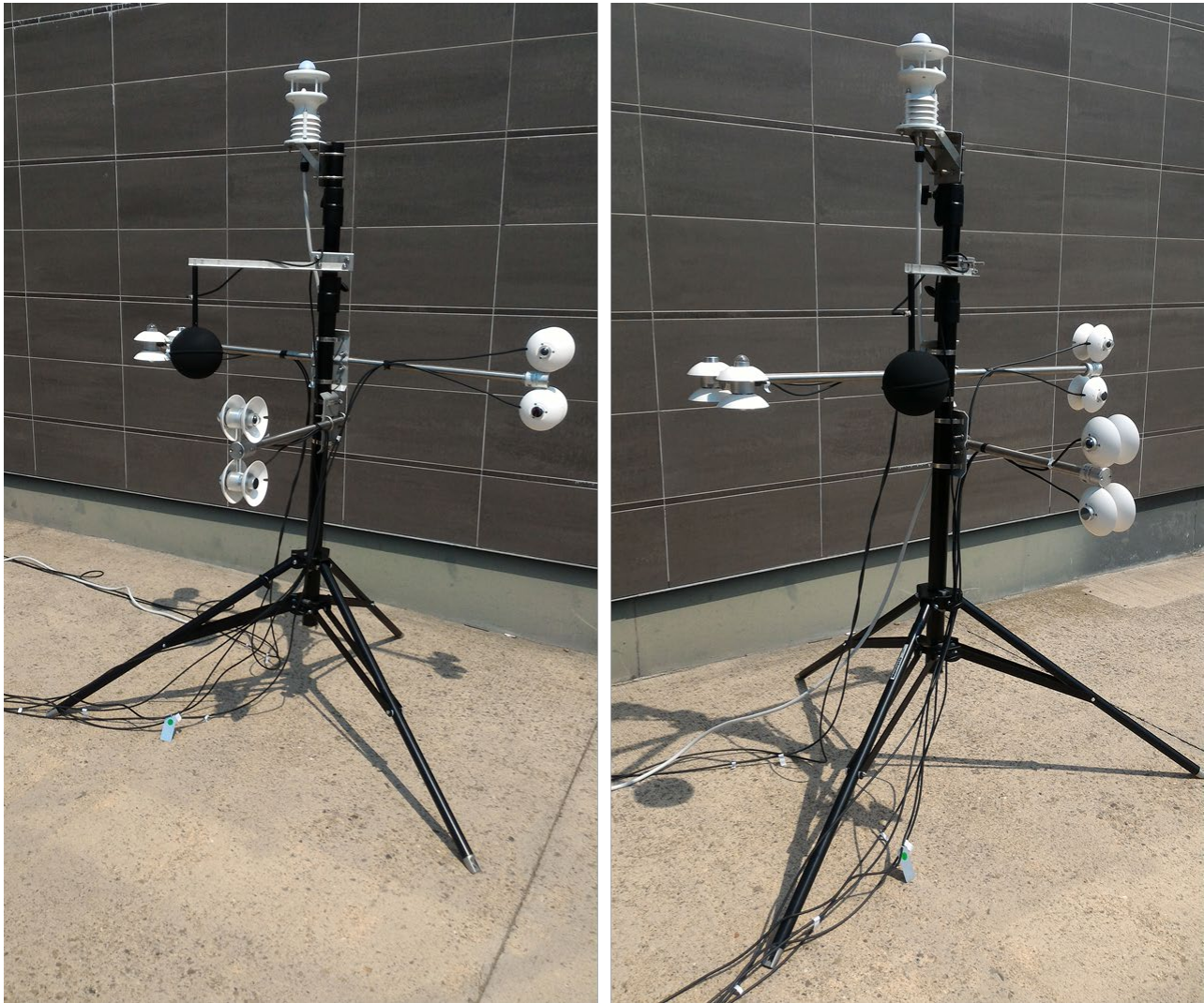
Figura 19. Misure effettuate in prossimità di una parete verticale con lastre di gres porcellanato
