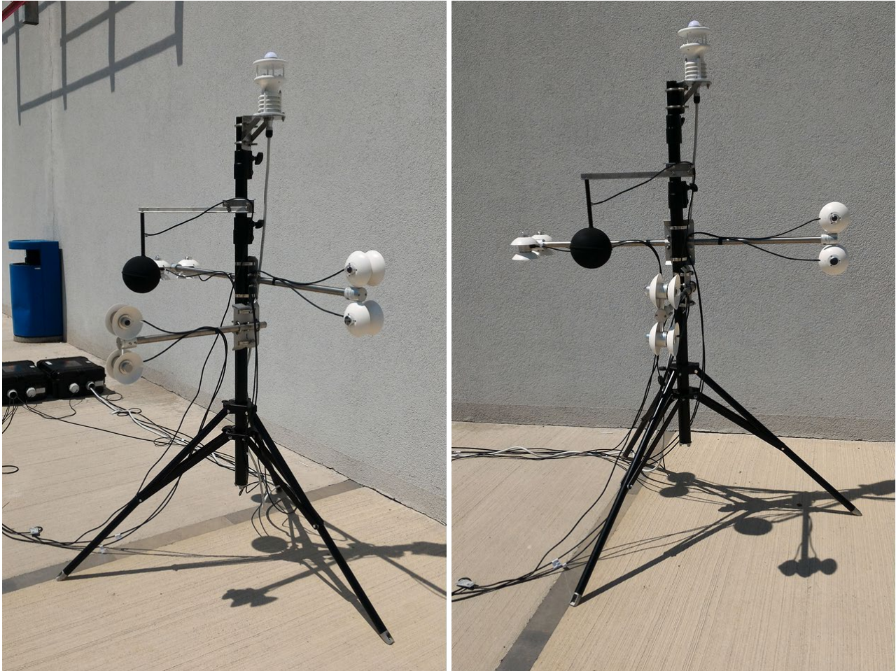
Figura 16. Misure effettuate in prossimità di una parete verticale con finitura in intonaco e pittura bianca
