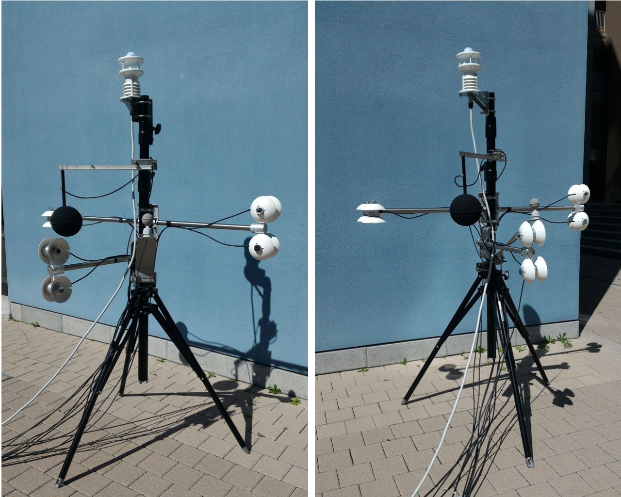
Figura 32. Misure effettuate in prossimità di una parete verticale con intonaco e pittura celeste. Giorno 01/09/2020
