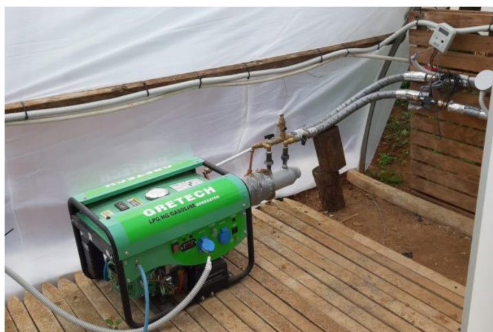
Figura 4-9: Motore a combustione interna installato presso il laboratorio sperimentale per provare il sistema di micro cogenerazione da biogas
