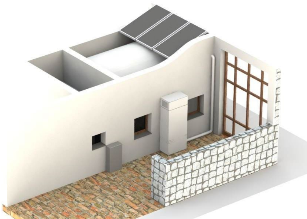
Figura 8. Ricostruzione 3D del sistema Freesco alimentato dai collettori solari.
