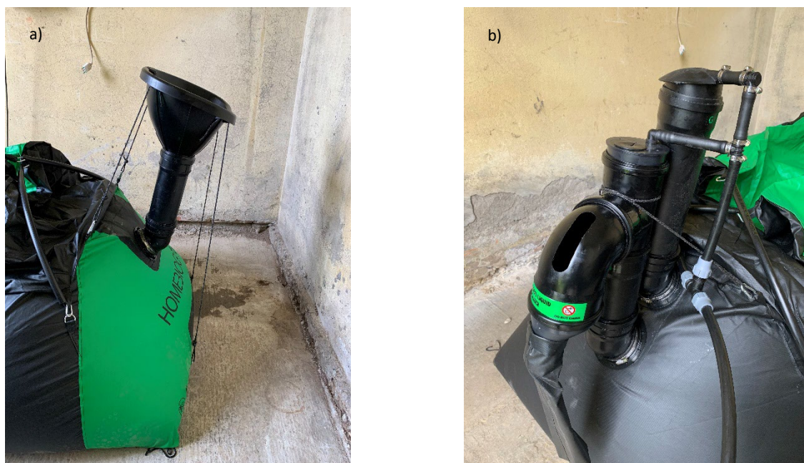
Figura 39 – Foto delle sezioni di ingresso della biomassa (a) e di uscita del biogas e del fertilizzante prodotti (b).
