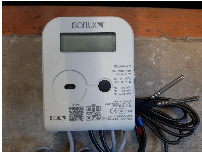
Figura 42 – Foto del contacalore per la contabilizzazione dello scambio termico acqua-fumi.
