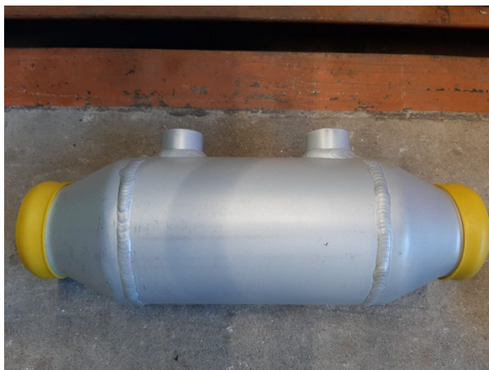
Figura 22 – Foto dello scambiatore di calore a fascio tubiero e mantello installato presso il Laboratorio di Meccanica dell'Alma Mater Studiorum – Università di Bologna.
