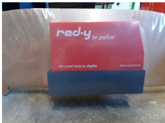
Figura 25 – Foto di uno dei due misuratori di portata (identici) installati.
