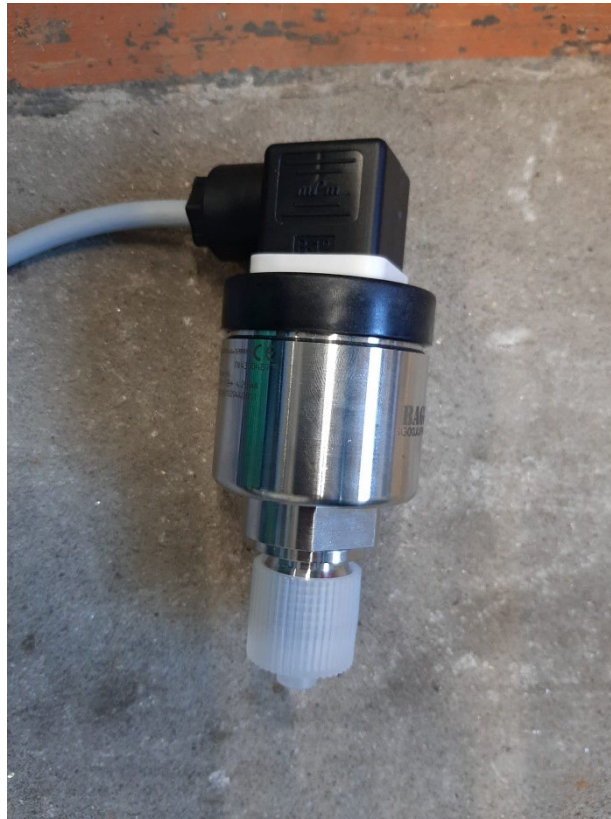
Figura 26 – Foto del sensore di pressione installato.
