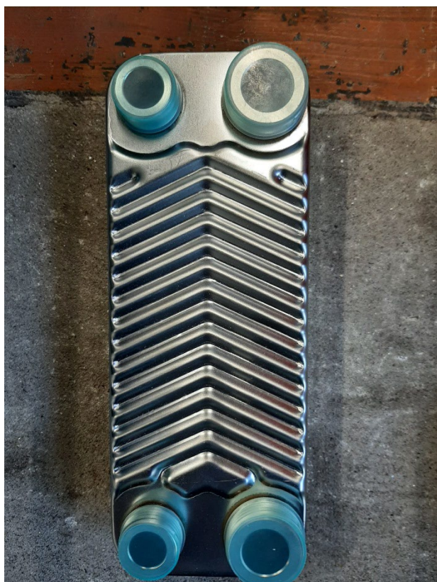
Figura 23 – Foto dello scambiatore a piastre installato presso il Laboratorio di Meccanica dell'Alma Mater Studiorum – Università di Bologna.
