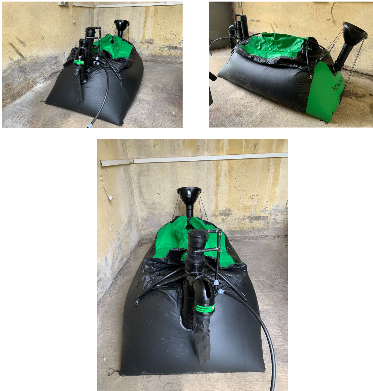
Figura 38 – Foto del digestore anaerobico installato in presso il Dipartimento di Scienze e Tecnologie Agroalimentari dell'Alma Mater Studiorum – Università di Bologna.
