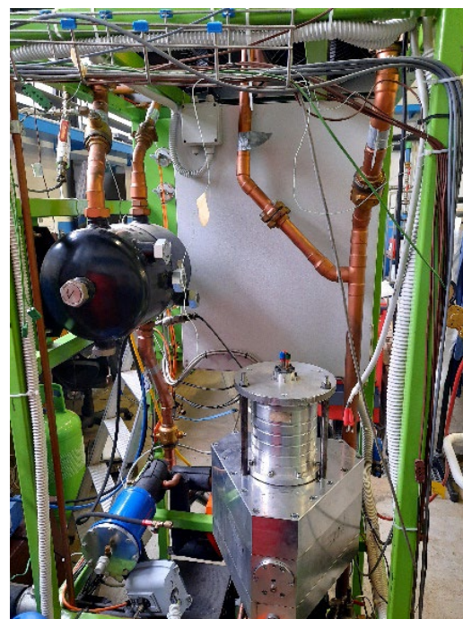
Figura 43 – Foto del banco prova ORC installato presso il Laboratorio di Tecnologie di Micro-generazione dell'Alma Mater Studiorum Università di Bologna.
