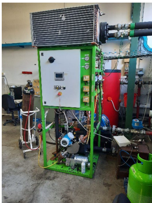
Figura 43 – Foto del banco prova ORC installato presso il Laboratorio di Tecnologie di Micro-generazione dell'Alma Mater Studiorum Università di Bologna.
