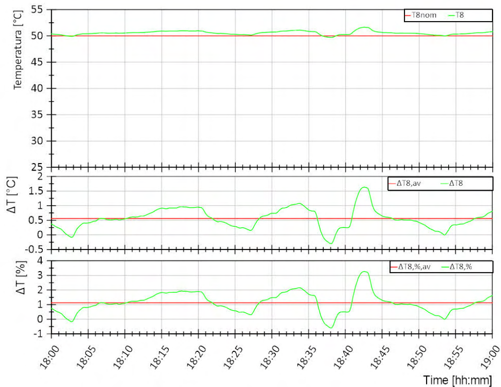
Figura 5.38. Scenario 3. Andamento della temperatura di ritorno dall'utenza T8 (curva verde, grafico superiore) e differenza rispetto al valore di riferimento T8nom in termini assoluti (curva verde, grafico intermedio) e percentuali (curva verde, grafico inferiore). Per ogni grandezza nei grafici sono riportati i valori medi di tutta la prova in rosso.
