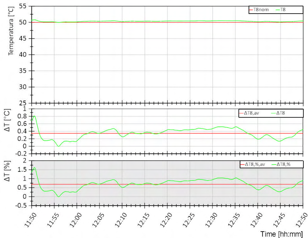
Figura 5.16. Scenario 1, richiesta utenza minima. Andamento della temperatura di ritorno dall'utenza T8 (curva verde, grafico superiore) e differenza rispetto al valore di riferimento T8nom in termini assoluti (curva verde, grafico intermedio) e percentuali (curva verde, grafico inferiore). Per ogni grandezza nei grafici sono riportati i valori medi di tutta la prova in rosso.
