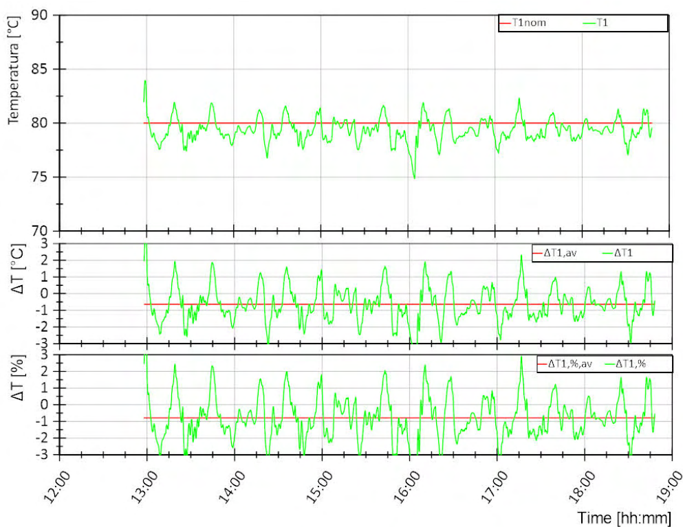
Figura 5.122. Prova dinamica 7. Andamento della temperatura di mandata dal teleriscaldamento T1 (curva verde, grafico superiore) e differenza rispetto al valore di riferimento T1nom in termini assoluti (curva verde, grafico intermedio) e percentuali (curva verde, grafico inferiore). Per ogni grandezza nei grafici sono riportati i valori medi di tutta la prova in rosso.
