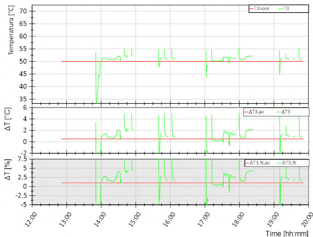
Figura 5.102. Prova dinamica 4. Andamento della temperatura di ritorno dal teleriscaldamento T3 (curva verde, grafico superiore) e differenza rispetto al valore di riferimento T3nom in termini assoluti (curva verde, grafico intermedio) e percentuali (curva verde, grafico inferiore). Per ogni grandezza nei grafici sono riportati i valori medi di tutta la prova in rosso.
