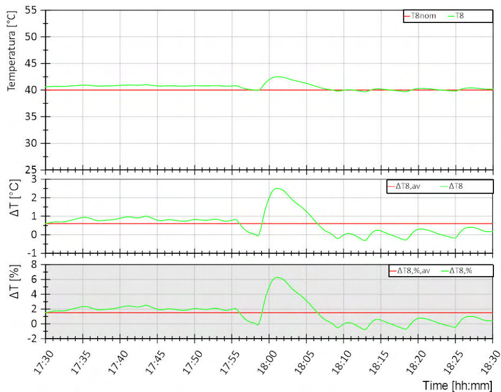
Figura 5.9. Scenario 1, richiesta utenza di design. Andamento della temperatura di ritorno dall'utenza T8 (curva verde, grafico superiore) e differenza rispetto al valore di riferimento T8nom in termini assoluti (curva verde, grafico intermedio) e percentuali (curva verde, grafico inferiore). Per ogni grandezza nei grafici sono riportati i valori medi di tutta la prova in rosso.
