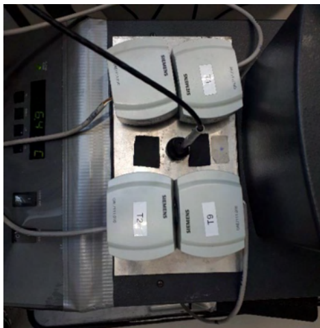
Figura 5.146. Bagno termostatico e posizionamento dei sensori da tarare e del sensore di riferimento durante la taratura
