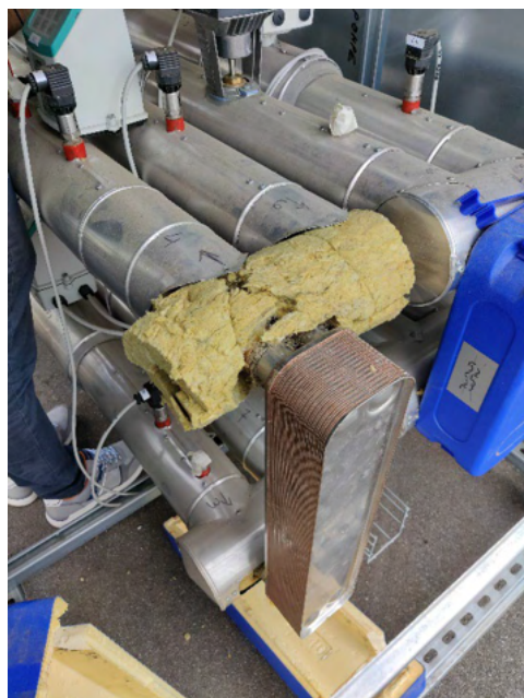
Figura 5.144. Scambiatore sovradimensionato (sinistra) e scambiatore sostitutivo (destra)
