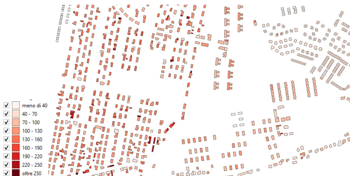
Figura 3.4 – Risultati del calcolo invernale per edificio (kWh/m²).
