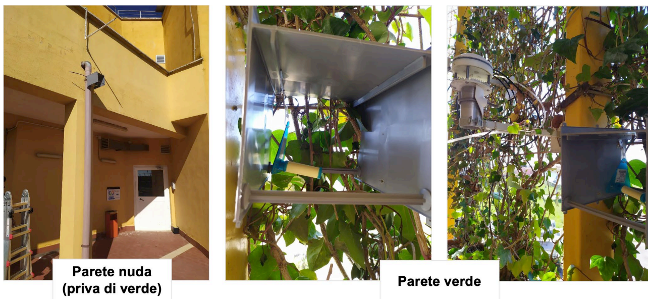
Figura 14. Campionamenti BTEX sulla parete nuda e sulla parete verde tra le foglie presso il CR ENEA Casaccia (inizio primavera 2021).
