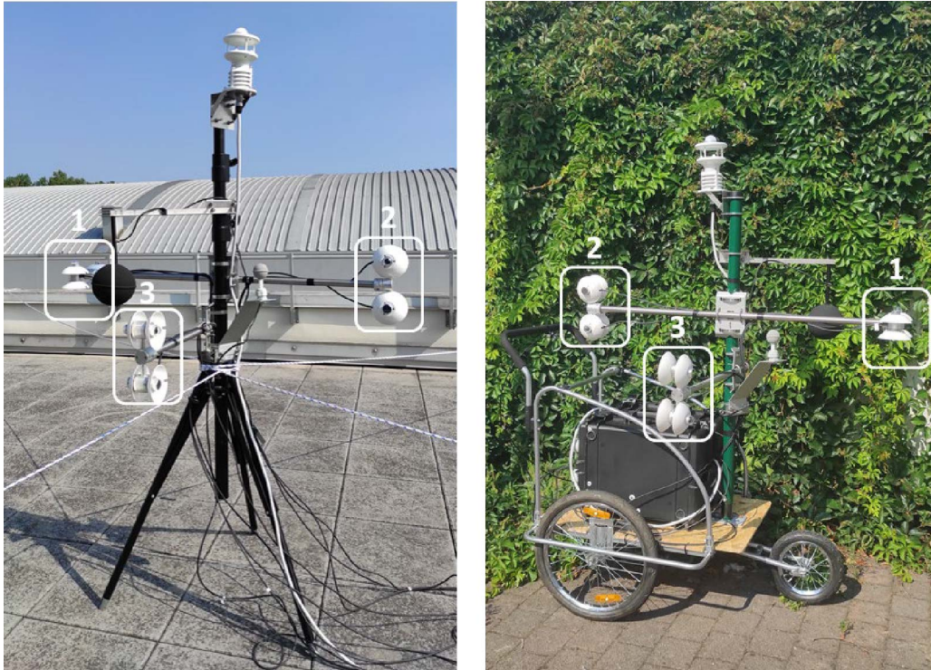
Figura 2. Set-up sperimentale per la rilevazione simultanea dei flussi radiativi: tre radiometri netti sono installati secondo le tre direzioni spaziali.
