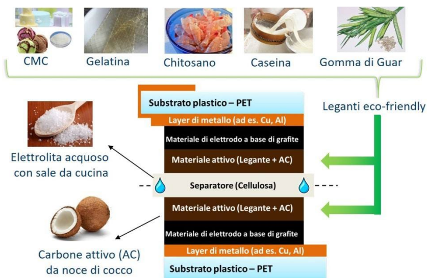
Figura 2. Struttura dei supercapacitori e provenienza dei materiali utilizzati come strato attivo ed elettrolita acquoso.
