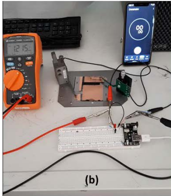
Figura 48. (a) Schema circuitale per caricare tramite porta USB il supercapacitore fabbricato ed il diodo LED di test a 3.3 V. Fotografie del setup sperimentale durante (b) la fase iniziale con LED spento e SC parzialmente carico a 1.2 V, (c) la fase di carica tramite USB e (d) la fase di scarica del generatore di corrente dc.
