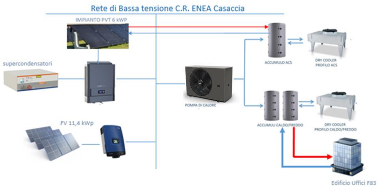
Figura 13: Schema generale sistema sperimentale S.A.P.I.EN.T.E. post integrazione nuovi componenti impiantistici.
