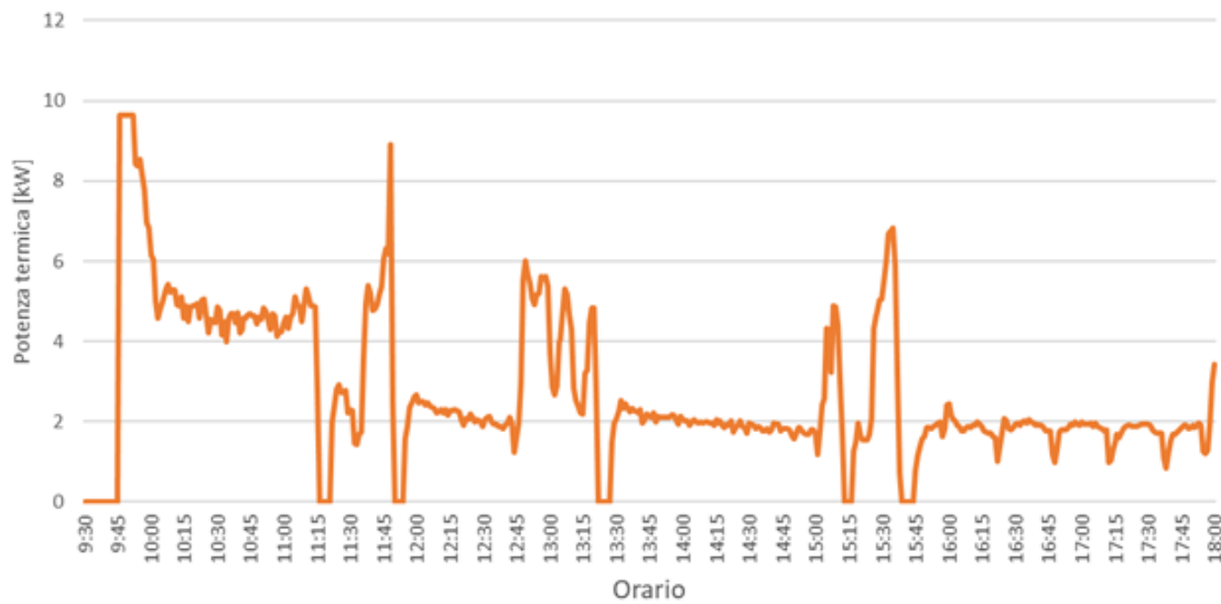
Figura 17: Andamento temporale della potenza termica scambiata tra ACC2 e la colonna montante dell'edificio F-83.
