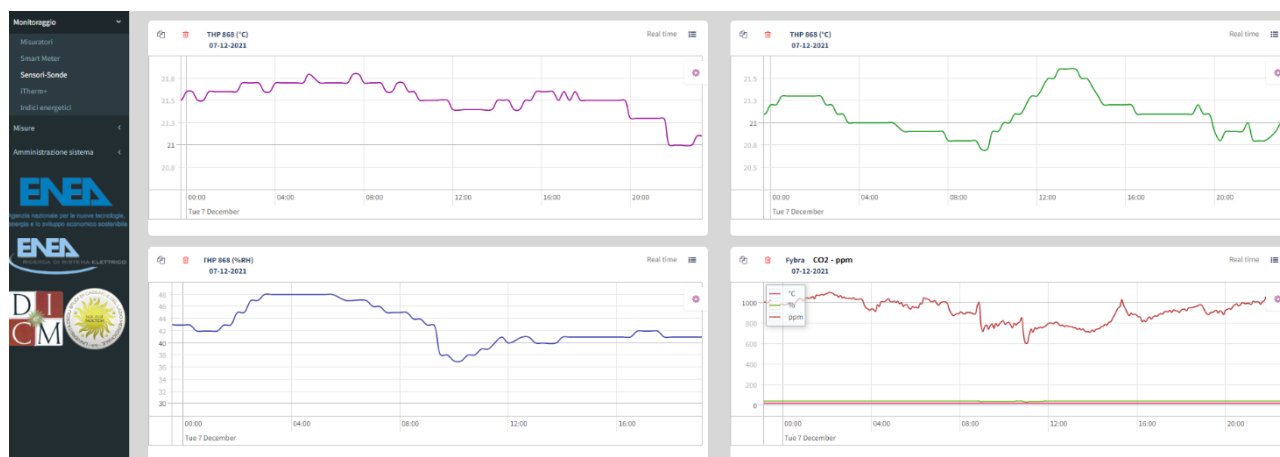
Figura 109: Appartamento secondo piano -3.1 - Andamento istantaneo della concentrazione di CO 2 (ppm), temperatura ambiente e umidità relativa rilevati da alcuni sensori installati all'interno dell'appartamento – giorno 7 Dicembre 2021.
