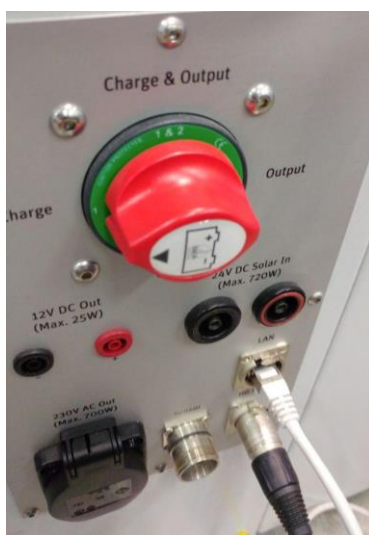
Figura 13 - Fronte e retro del deviatore a quattro vie
