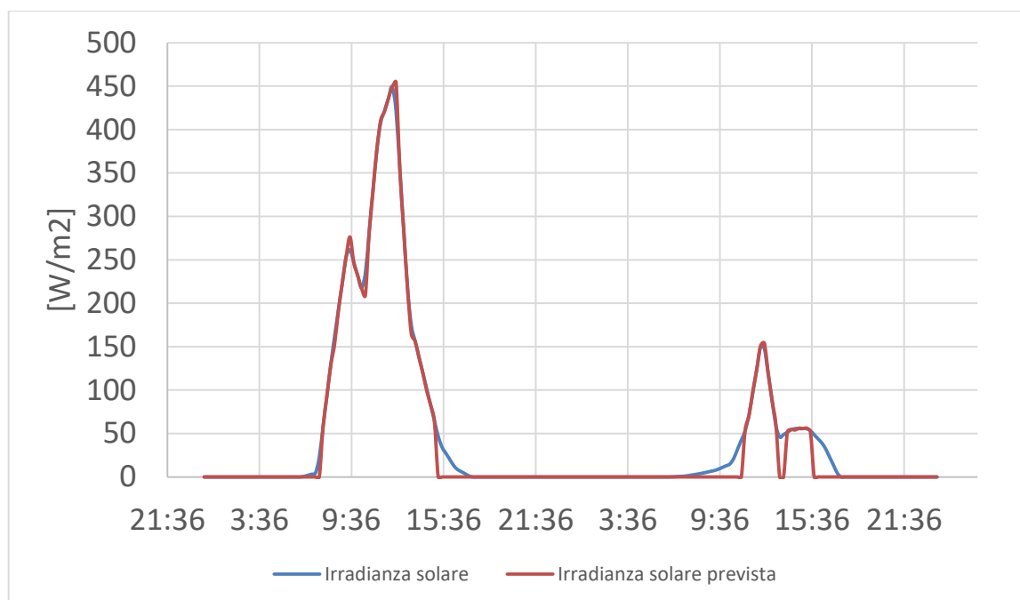
Figura 158. Confronto tra radiazione solare e valori previsti per il controllo della pompa di calore.
