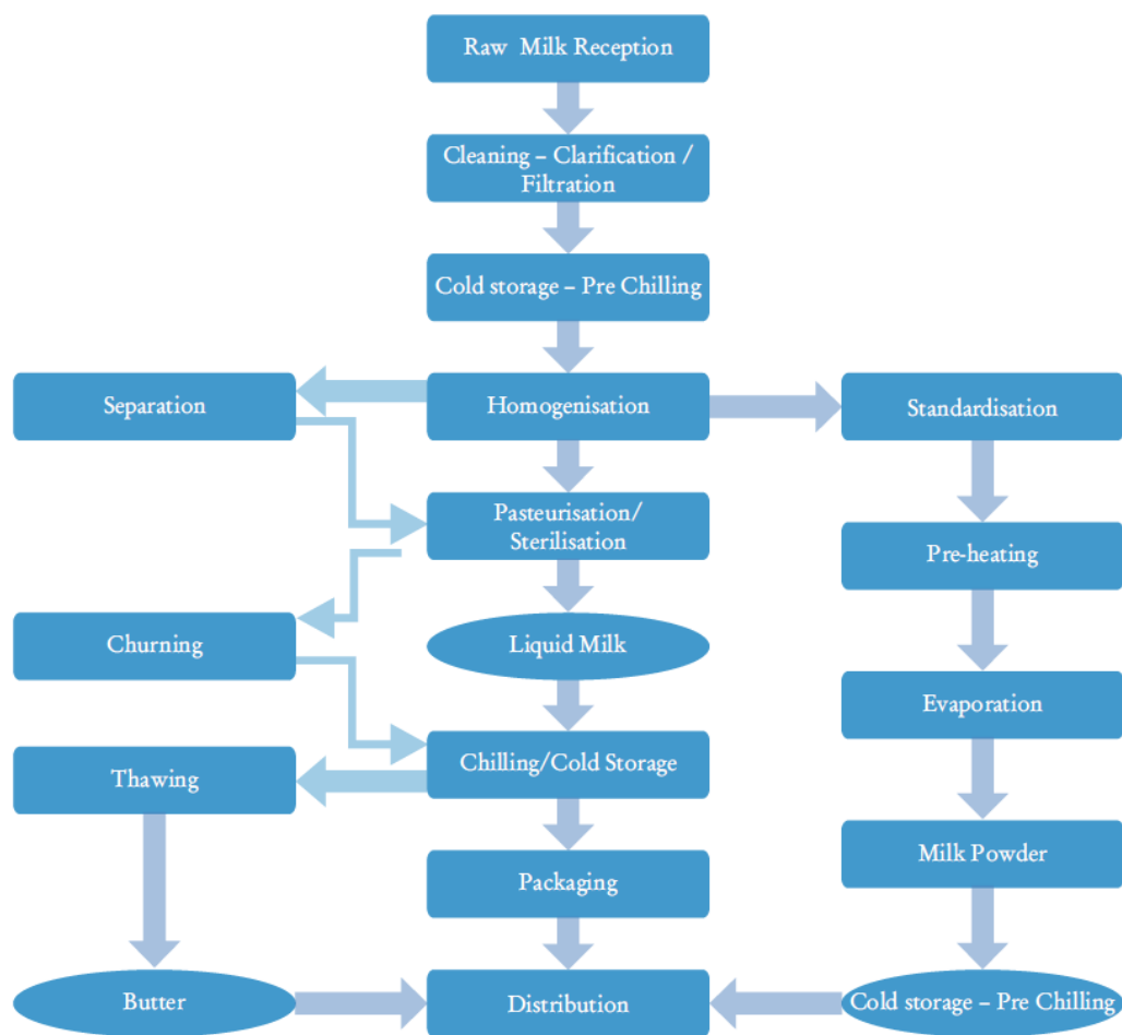
Figura 30. Schema sintetico del processo di trasformazione del latte crudo in latte pastorizzato, burro e latte in polvere [5]
