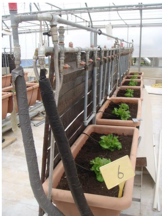
Figura 24. Sistema di distribuzione del freddo/caldo denominato “piastre”.
