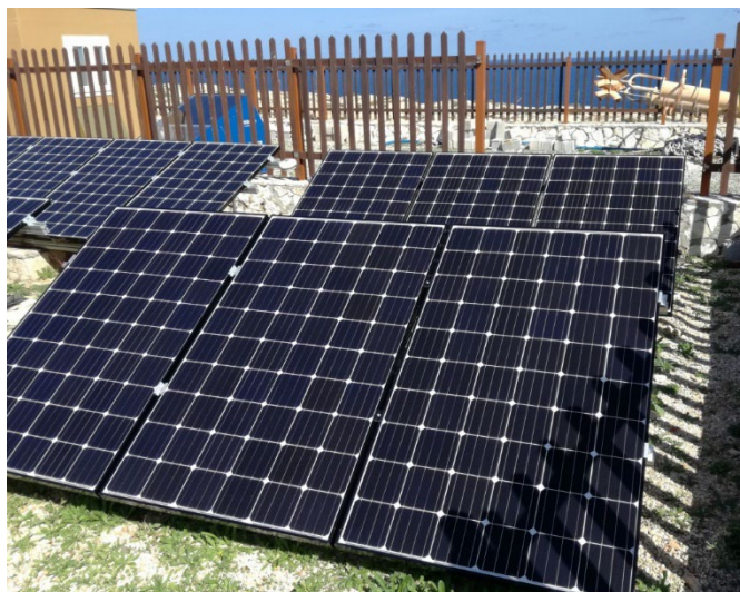
Figura 174: Impianto per lo studio dell'effetto della deposizione sulla produzione dei pannelli fotovoltaici
