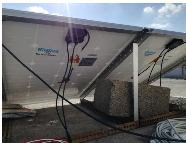
Figura 180: Parte posteriore dei due pannelli installati sul tetto del Dipartimento di Fisica; il pannello di destra viene pulito regolarmente, e fornisce la produzione di riferimento. Il pannello di sinistra non viene pulito e permette di stimare l'effetto del soiling.
