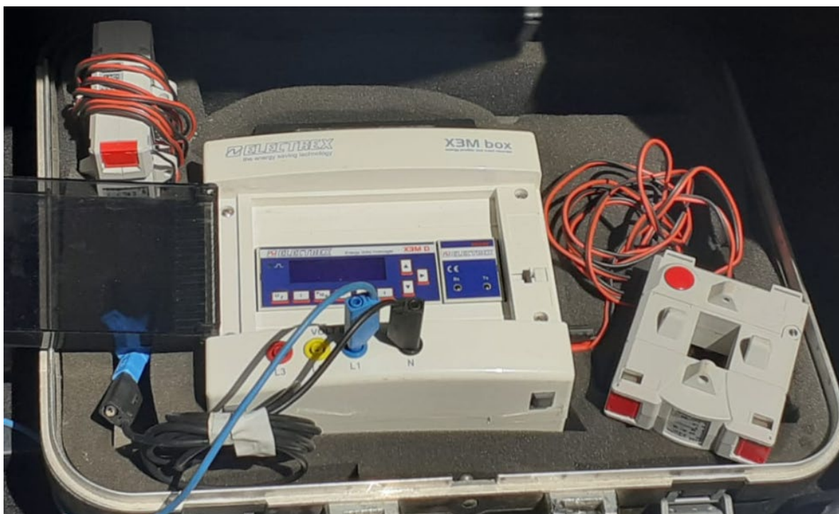
Figura 131: multimetro digitale con trasformatore amperometrico per le misura della potenza elettrica erogata dal motore e assorbita dalla pompa di calore
