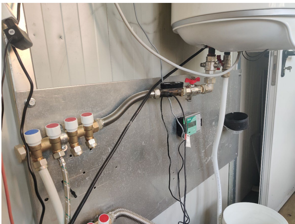
Figura 69: Sistema di test per lo scaldacqua smart. Rappresentazione d'insieme del circuito, lato mandata dello scaldacqua
