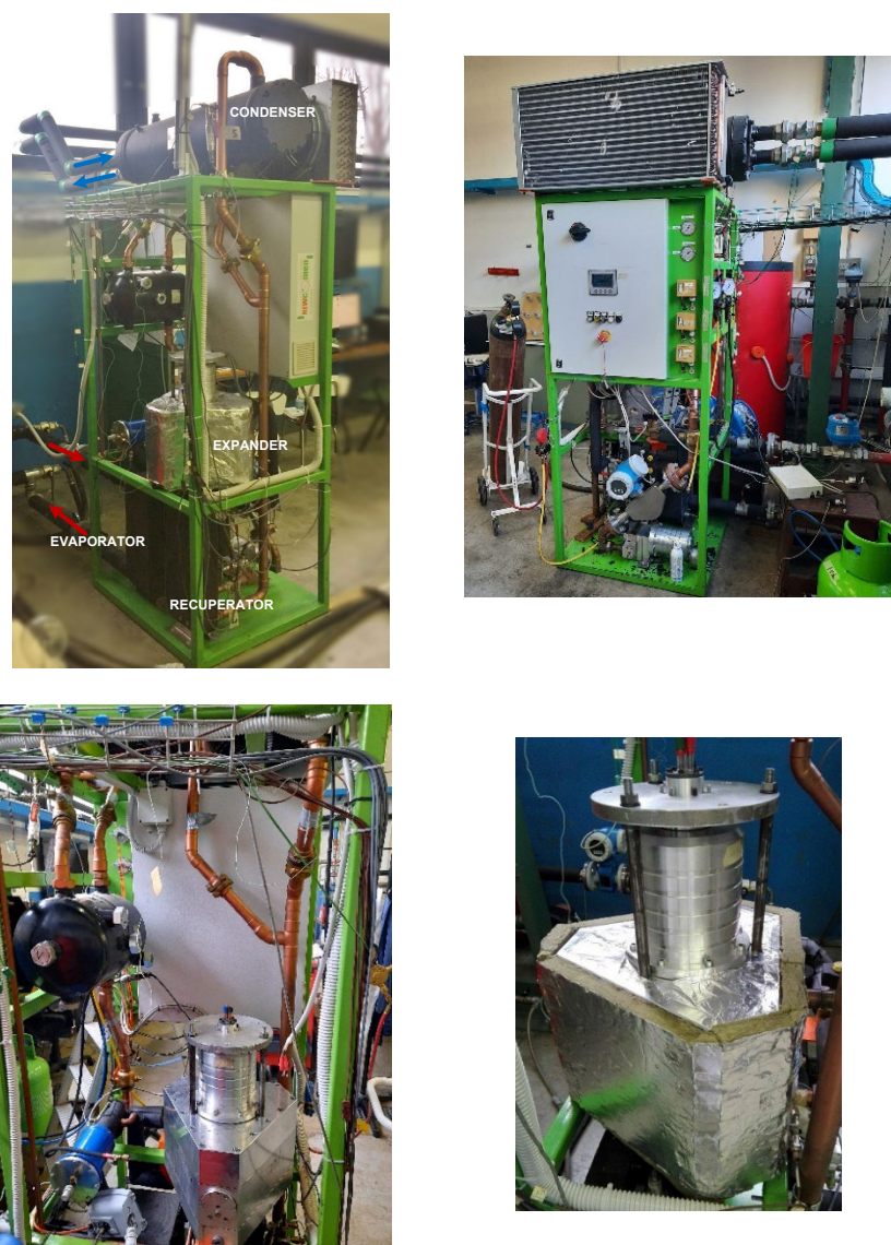
Figura 45 – Foto del banco prova ORC installato presso il Laboratorio di Tecnologie di Micro-generazione dell’Alma Mater Studiorum Università di Bologna.
