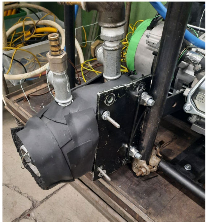
Figura 25 – Foto della linea di scarico del motore nella configurazione ottimizzata (senza marmitta e con scambiatore coibentato).
