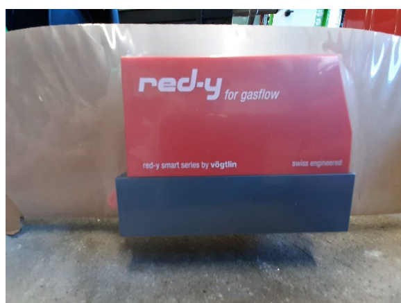
Figura 10 – Immagini del misuratore di portata in massa termico.
