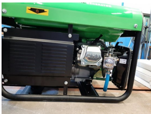
Figura 5 – Immagine del motore a combustione interna multi-fuel.
