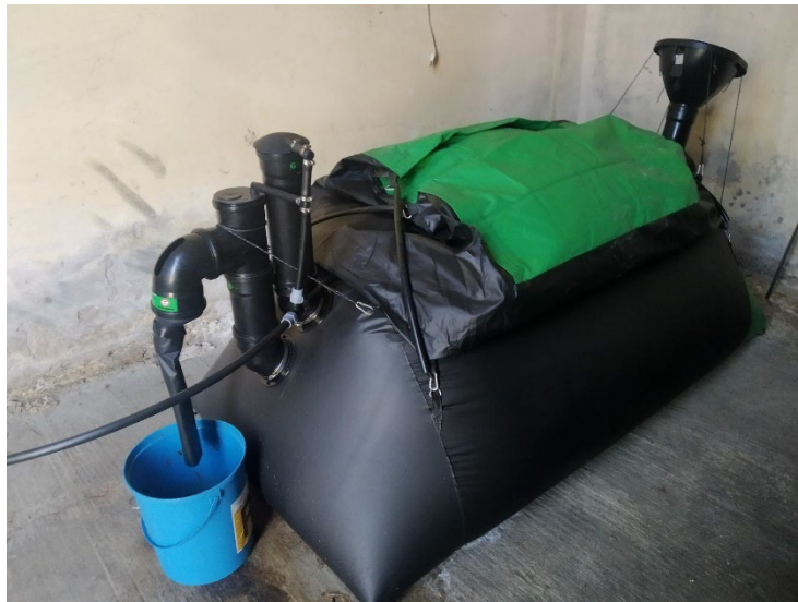
Figura 4 – Immagine del digestore anaerobico HomeBiogas 2.0 [1].
