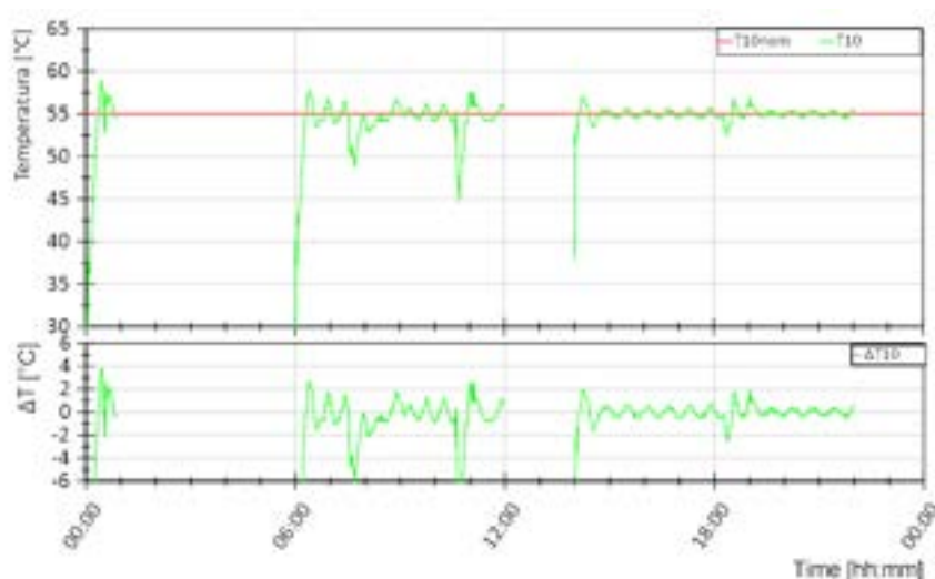
Figura 3.199. Sessione B1, Giorno 1. Andamento della temperatura di mandata all'utenza T10 (curva verde, grafico superiore) e differenza rispetto al valore di riferimento T10nom in termini assoluti (curva verde, grafico inferiore)
