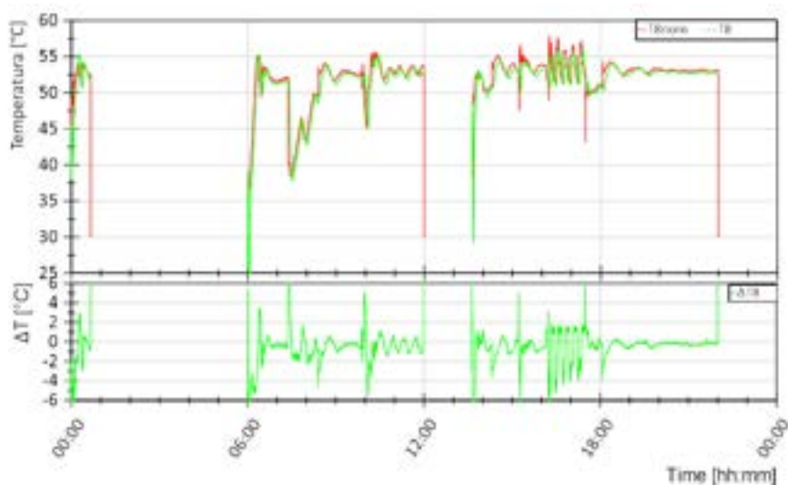
Figura 5.53. Sessione B1, Giorno 2. Andamento della temperatura di ritorno dall'utenza T8 (curva verde, grafico superiore) e differenza rispetto al valore di riferimento T8nom in termini assoluti (curva verde, grafico inferiore)
