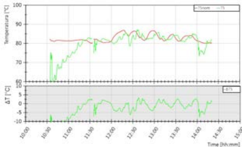
Figura 5.13. Sessione A, Giorno 2 - Dettaglio. Andamento della temperatura di mandata dal sistema di generazione T5 (curva verde, grafico superiore) e differenza rispetto al valore di riferimento T5nom in termini assoluti (curva verde, grafico inferiore)
