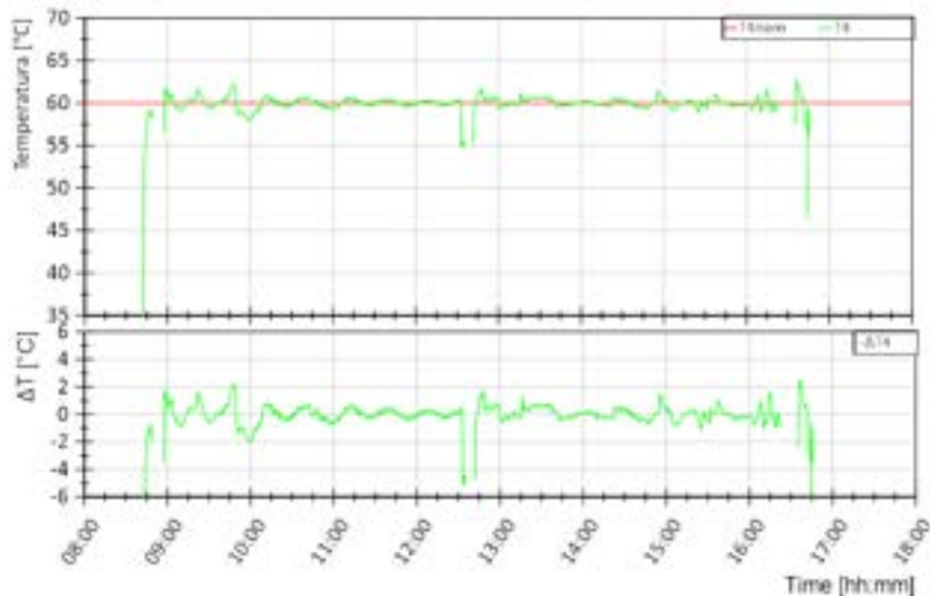
Figura 3.228. Sessione B1, Giorno 5 - Dettaglio. Andamento della temperatura di immissione in rete T4 (curva verde, grafico superiore) e differenza rispetto al valore di riferimento T4nom in termini assoluti (curva verde, grafico inferiore)
