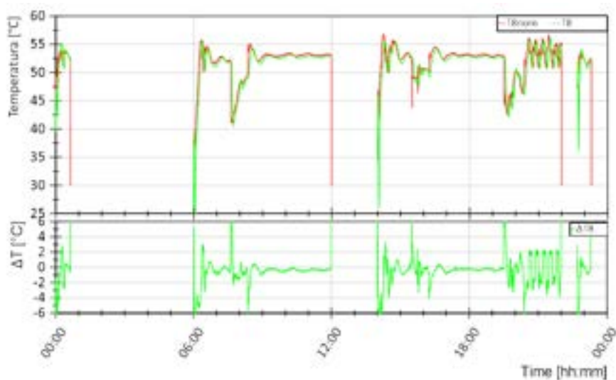
Figura 5.79. Sessione B1, Giorno 6. Andamento della temperatura di ritorno dall'utenza T8 (curva verde, grafico superiore) e differenza rispetto al valore di riferimento T8nom in termini assoluti (curva verde, grafico inferiore)
