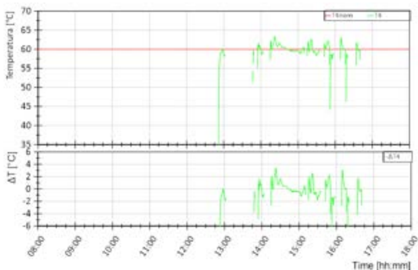
Figura 5.68. Sessione B1, Giorno 4 - Dettaglio. Andamento della temperatura di immissione in rete T4 (curva verde, grafico superiore) e differenza rispetto al valore di riferimento T4nom in termini assoluti (curva verde, grafico inferiore)
