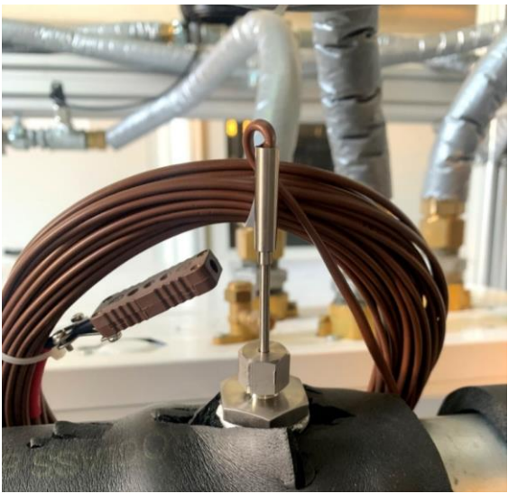
Figura 26. Termocoppia tipo T (Rame-Costantana).
