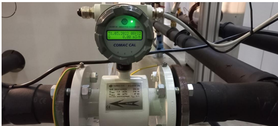
Figura 30. Misuratore di portata elettromagnetico (FLOW 38).
