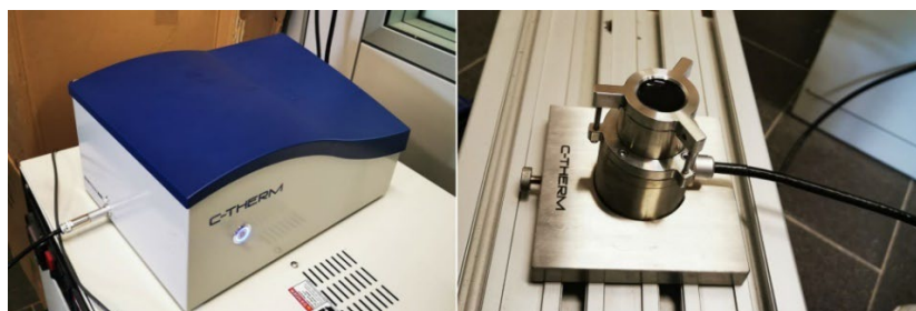
Figura 4. Misuratore di conducibilità termica C-THERM TCi.
