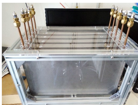
Figura 20. Evaporatore con PCM integrato.
