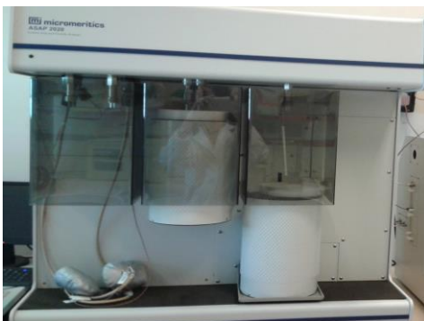
Fig 7 : Strumento per analisi BET e BJH della Micromeritics modello ASAP 2020 .
