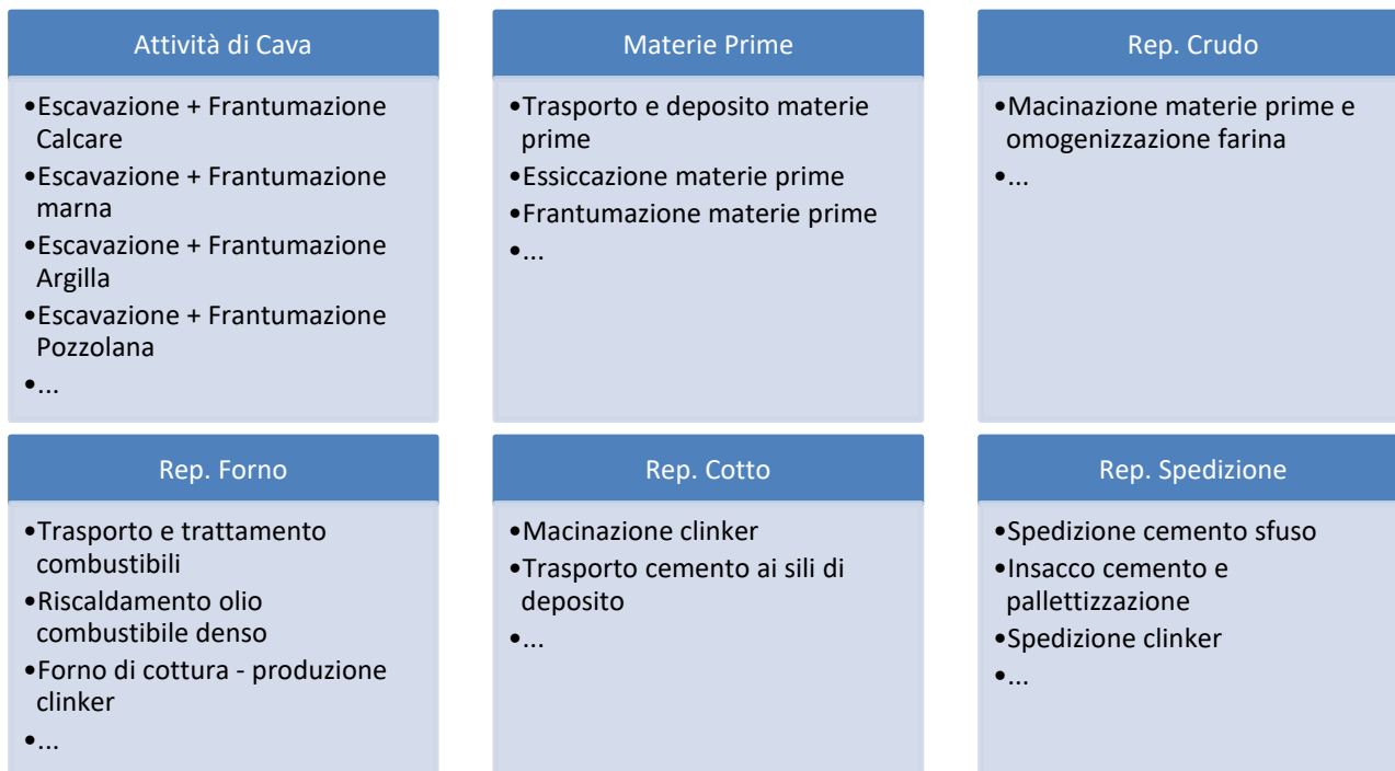
Figura 11 – Dettaglio fasi di processo per la produzione del cemento
