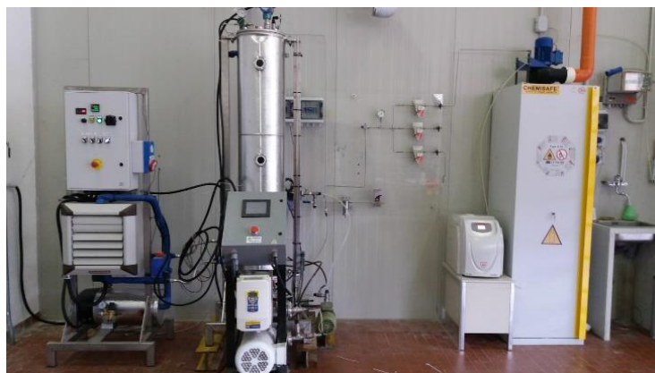
Figura 52 Apparato sperimentale utilizzato per effettuare le prove di metanazione idrogenotrofa
