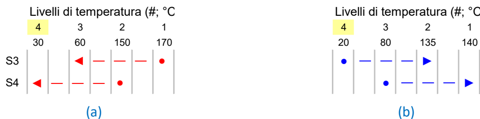
Figura 21. Intervalli di temperatura delle curve cumulative dei fluidi caldi (a) e freddi (b)
