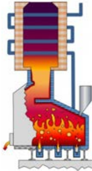
Figura 31. schema di funzionamento di un forno a fusione sommersa [40].
