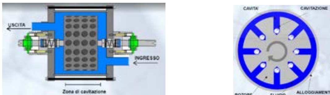
Figura 138 - Rappresentazione schematica del dispositivo di cavitazione idrodinamica controllata.
