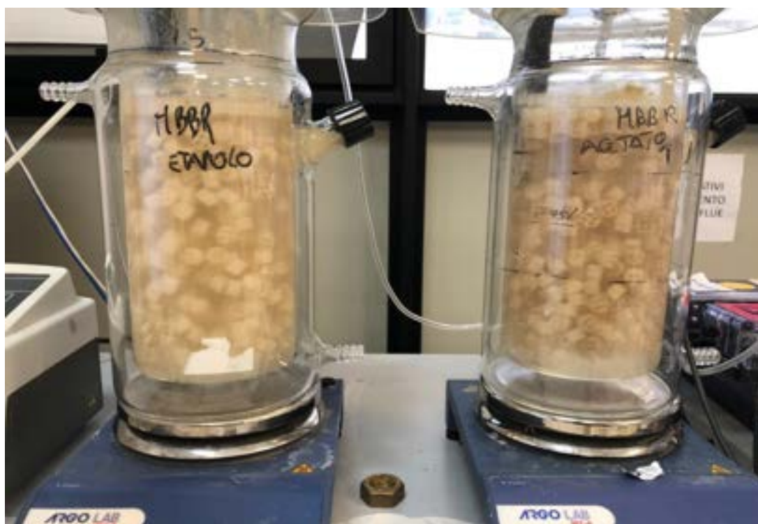
Figura 10. Reattori MBBR alimentati con diversa fonte di carbonio organico (etanolo ed acetato)
